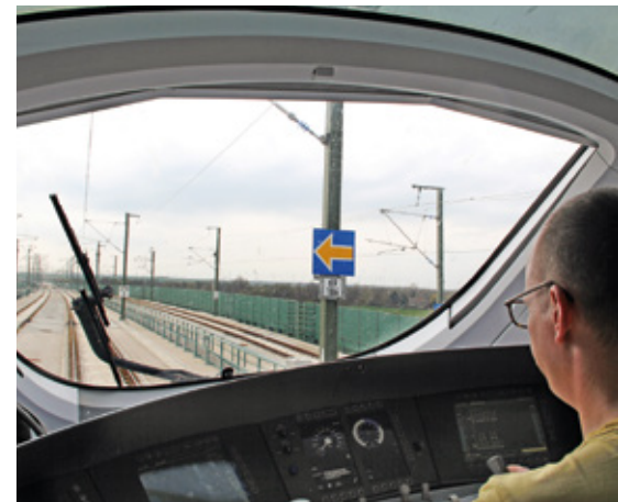
BILD 3: ICE-T Führerstand mit ETCS-Ausrüstung
