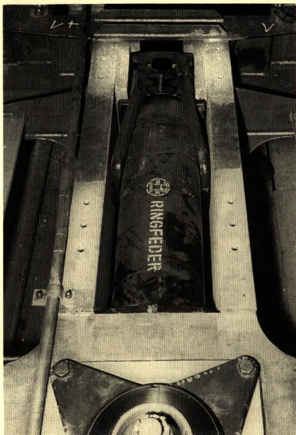
Bild 2: Zug-Druck-Federwerk der Bauart „Ringfeder“ mit Doppelbügel, eingebaut zwischen Zug- und Druckanschlägen des Drehgestellneubauwagens Rmms 663, von unten betrachtet.
