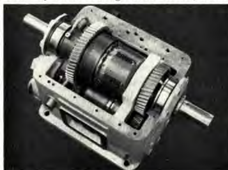
Kraftschlüssiges HURTH-Zweigang-Getriebe (geöffnet)
