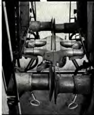
Werkversuche mit der automatischen +GF+ Kupplung (Stufe I gemäss U.I.C.) an Leichtstahlwagen der Schweizerischen Bundesbahn.
