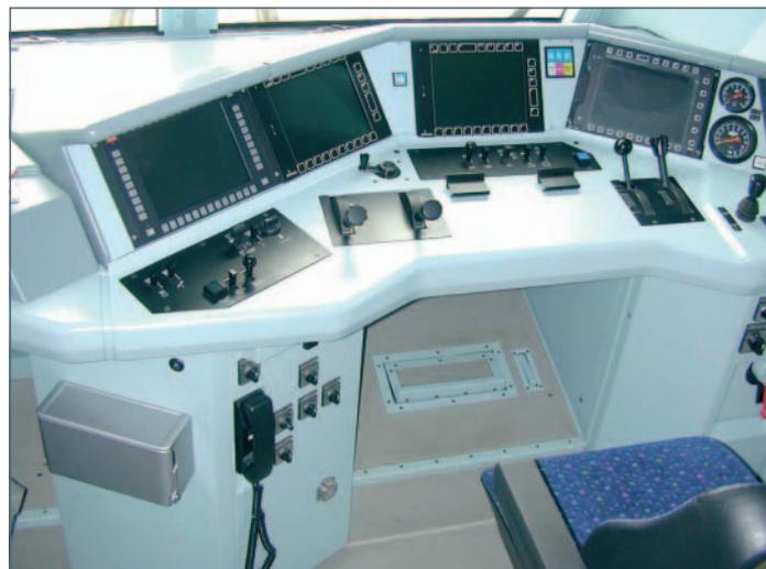
**BILD 5:** Bereits für ETCS vorgerüsteter Eurocab-Führertisch der TRAXX-Lokomotiven von Bombardier
