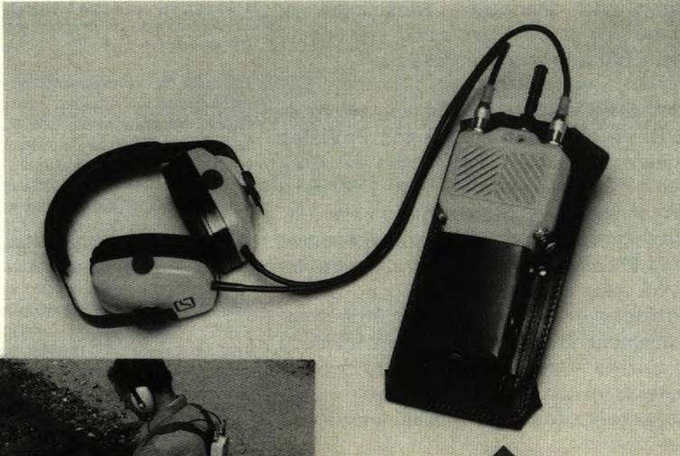
Bild 4: Entwicklung im Rahmen der ERRI-Frage A 158 — Systeme zur individuellen Warnung von Personen im Gleisbereich, Warnempfänger mit aktivem Gehörschutz
