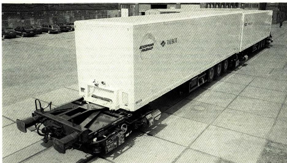
Bild 17: Kombitrailer-Einheit (NSB)
