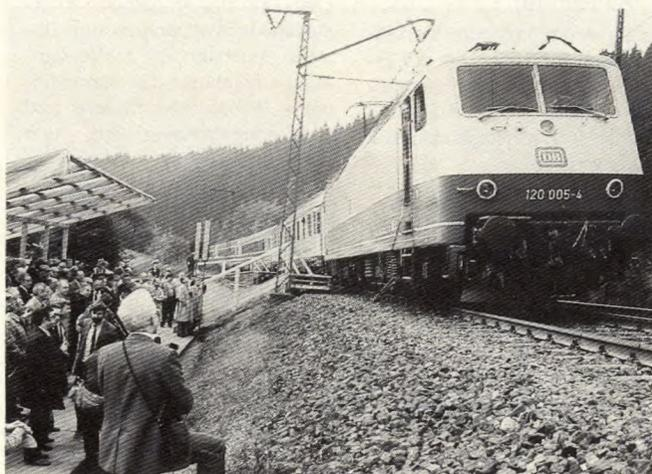
Anfahrt eines 780t schweren Zuges mit Lok 120 005 bei definierten Schienenzuständen (Steigung 21,7‰; Radius 382 m  $\triangleq$  1,99‰)
