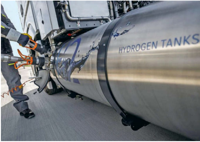
Flüssigwasserstofftank der SAG Group für mobile Anwendungen – auch im Schienenverkehr.
