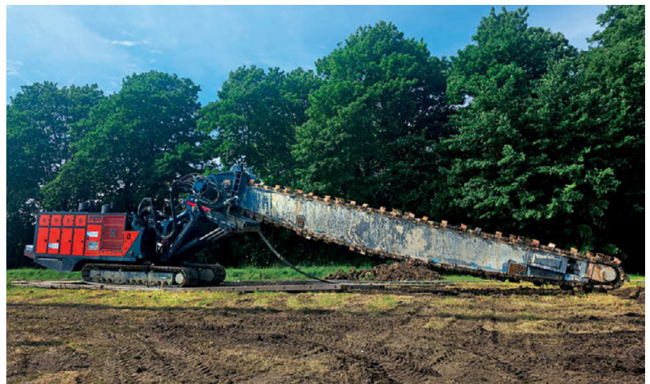
Abb. 1: Das verlängerte Schwert ermöglicht Tiefen bis zu 15 m.
