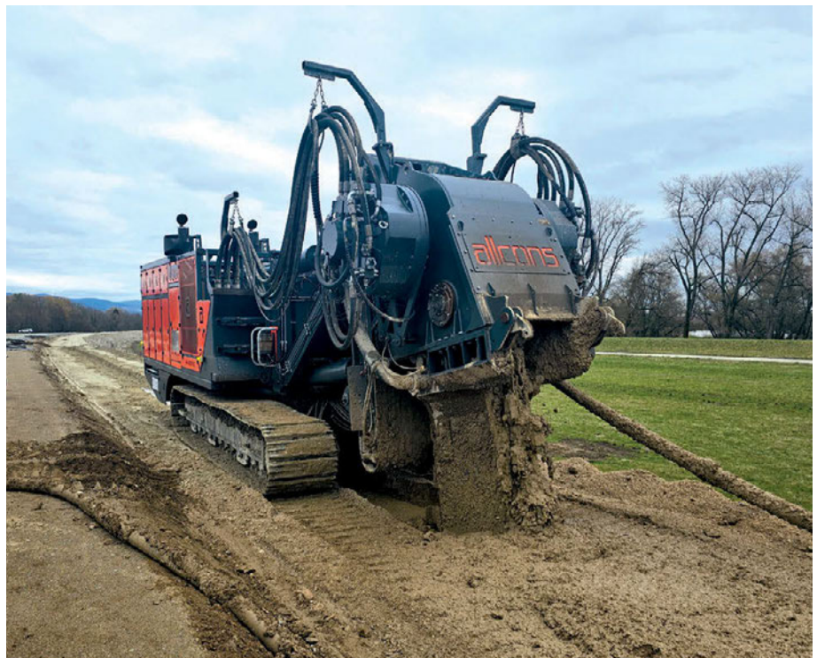
Abb. 2: Speziell entwickelte Fräse mit verlängertem Schwert im Einsatz
