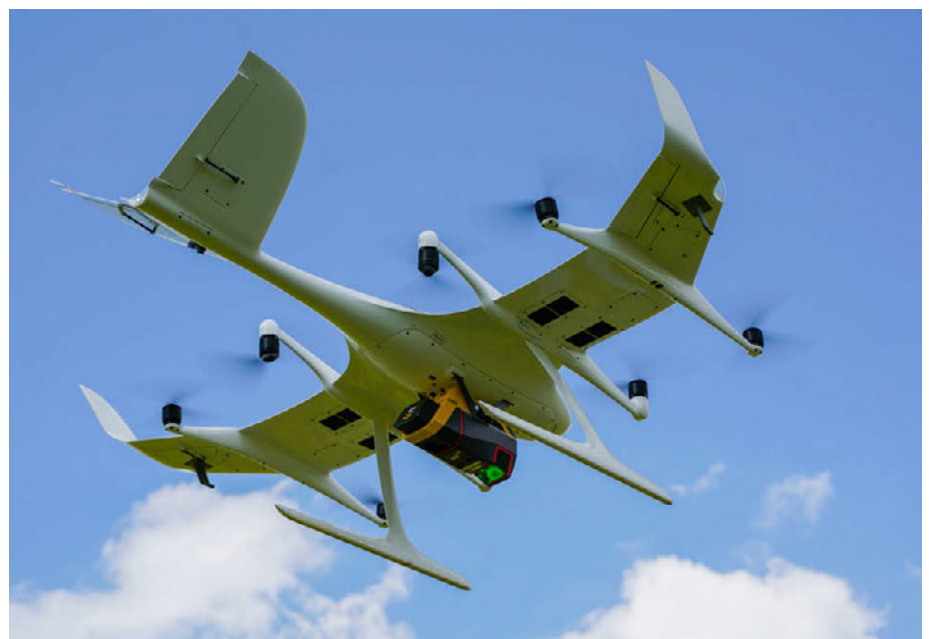
Abb. 1: Wingcopter 198 mit YellowScan Voyager
