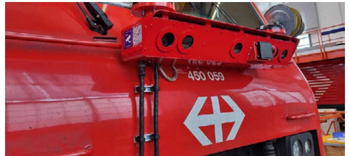
Sensoren zur Erkennung von Hindernissen an der Lokfront
