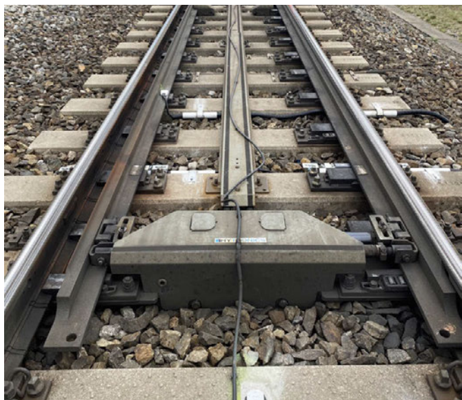
1: Eingebaute Messsensorik „zentrak IM“ der vaSIG in einer Zungenvorrichtung
