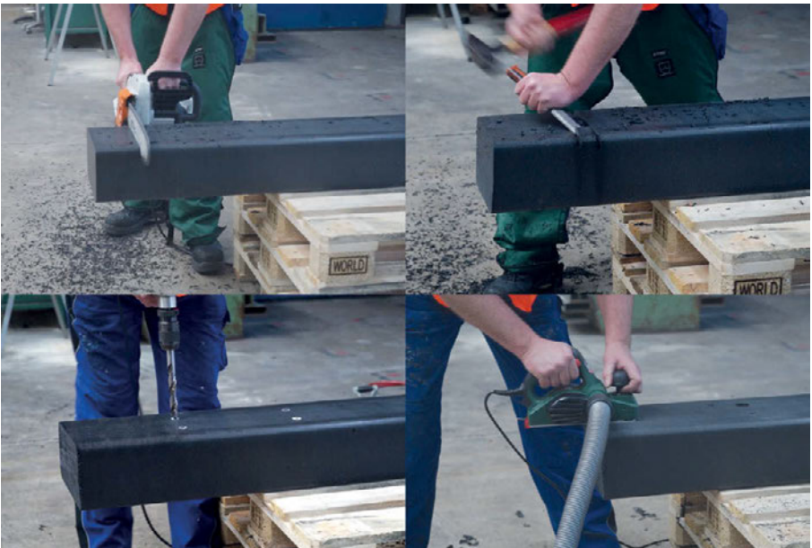
3: Die Bearbeitung der Kunststoffschwelle ist unbedenklich, erfordert keine Spezialausrüstung und kann mit handelsüblichen Werkzeugen vorgenommen werden
