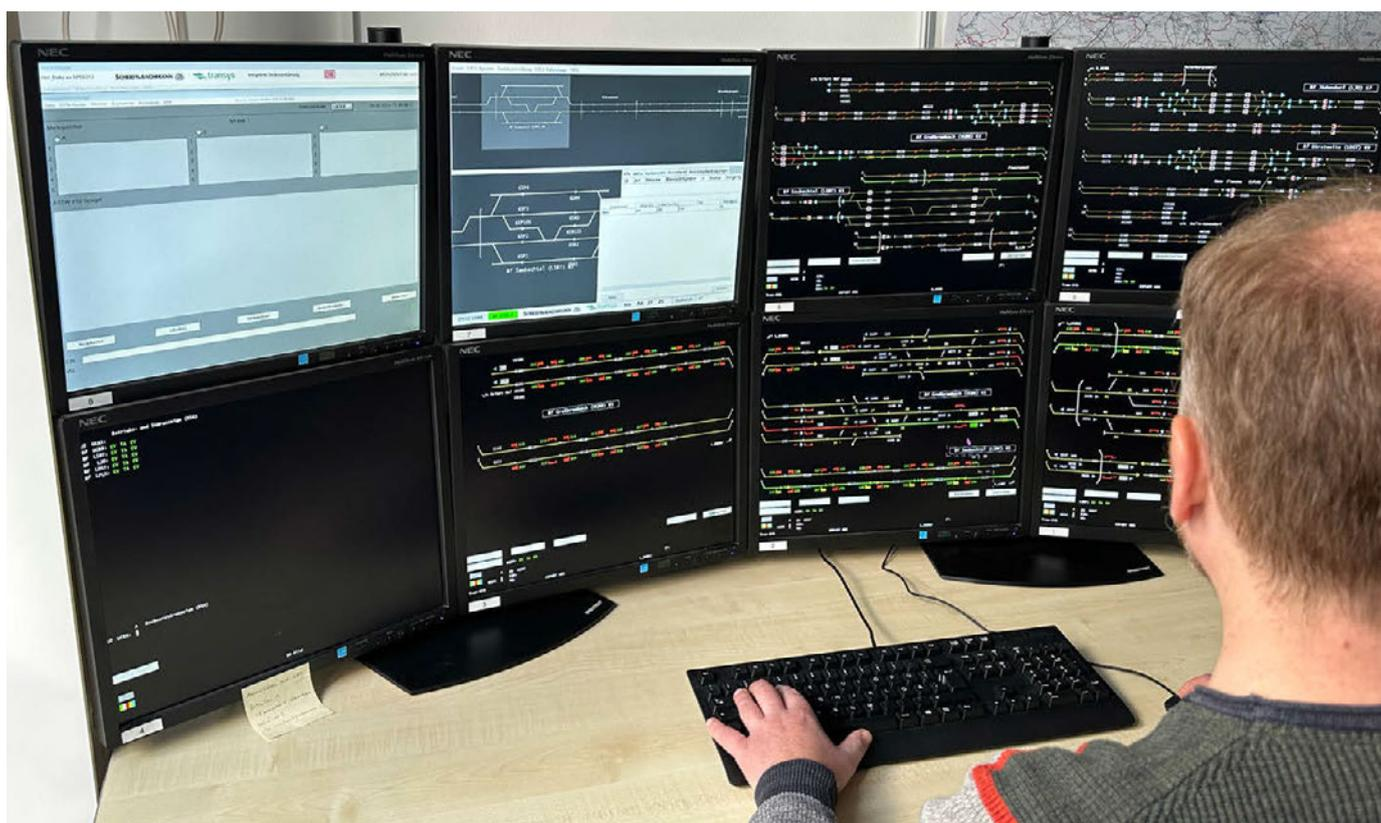
**Bild 1: Arbeitsplatz Schulungsanlage mit Bedienoberflächen für ESTW und ETCS-Z**
