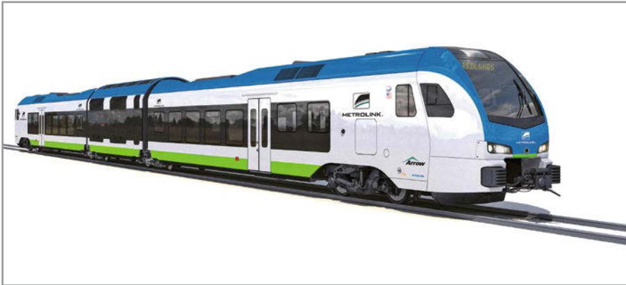
Abb. 7: Stadlers Flirt H2 für die San Bernadino County Transportation Authority wird erster Brennstoffzellenzug der USA.
