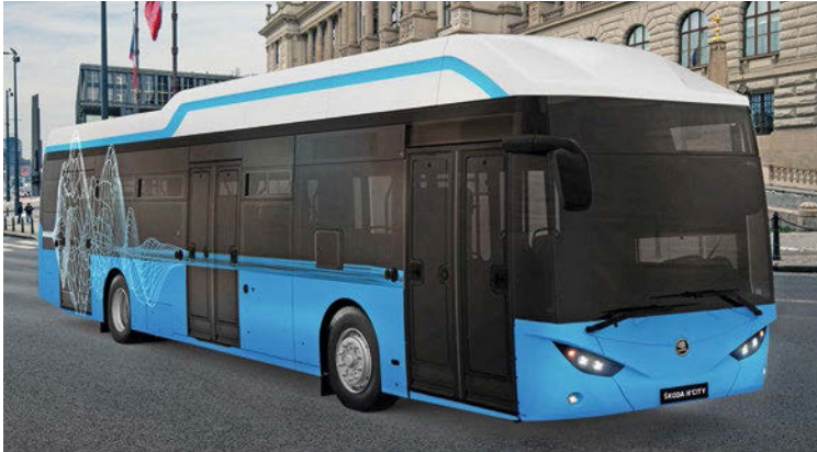
Abb. 10: Skodas Brennstoffzellenbus H'City basiert wie auch E- und O-Bus technisch auf dem Temsa Avenue. Grafik: Skoda Group
