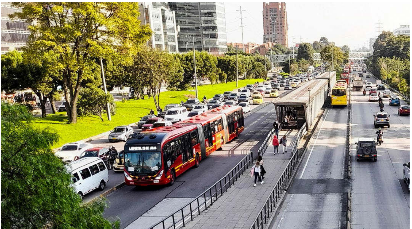
Abb. 2: High-Capacity-Busse haben eine Länge von über 30 Metern und eine Beförderungskapazität für rund 300 Personen. Foto: Arturo Rosenow/iStock
