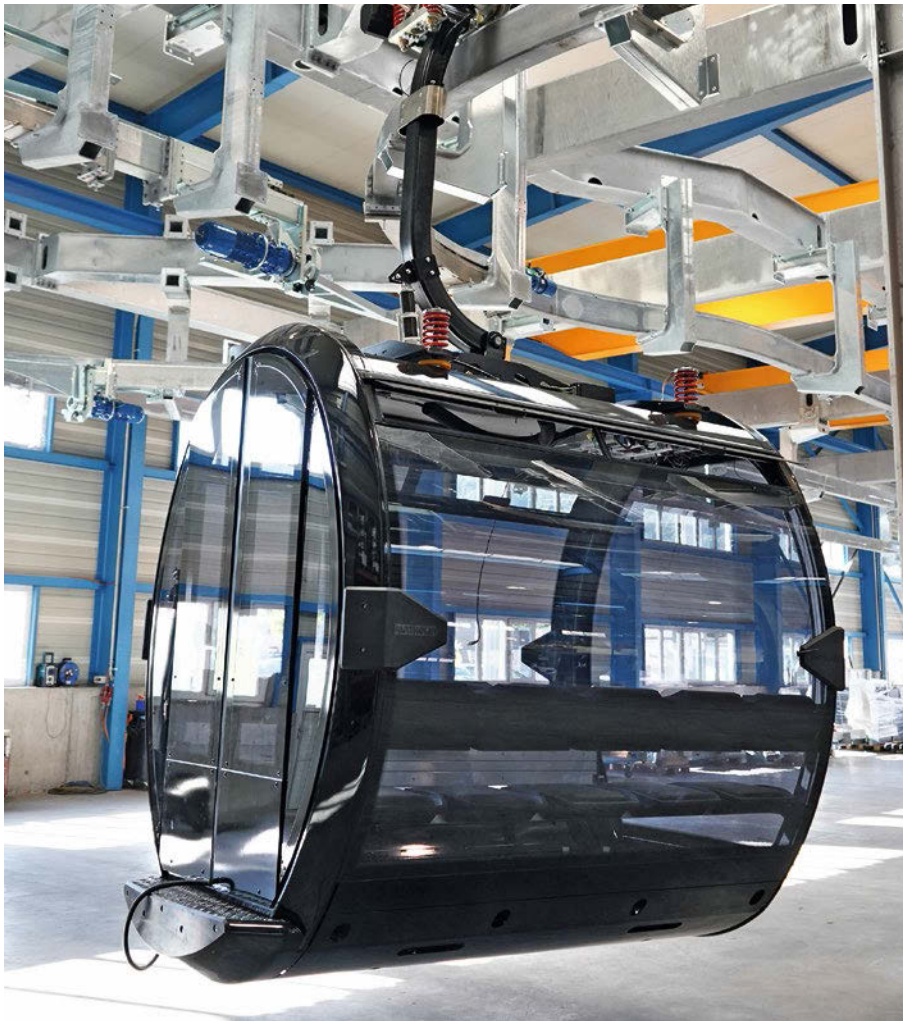
Abb. 11: Mit dem Ropetaxi, hier eine Kabine an einer Abzweigung der Leitschiene im Stationsbereich, will Barholet urbanen Seilbahnen neue Möglichkeiten verschaffen. Foto: Barholet
