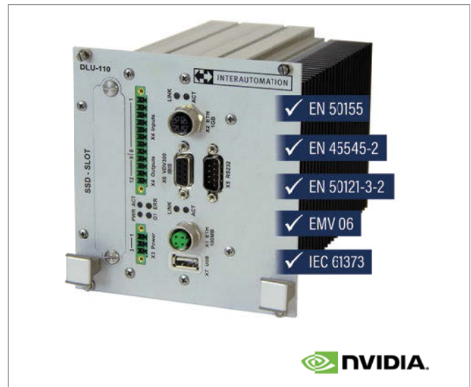
Abb. 1: DLU-110 – Hochleistungs-Bordrechner mit NVIDIA®-GPU und Bahnzulassung, ideal für KI-Anwendungen.
