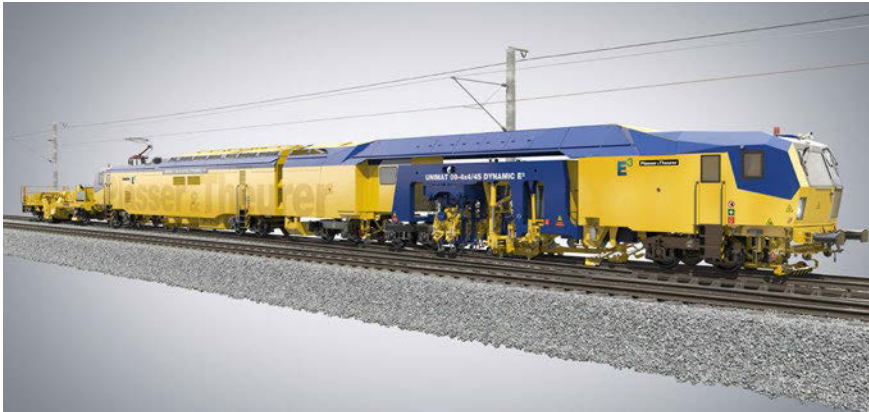
Abb. 1: Der Unimat 09-4x4/4S Dynamic E 3 mit E 3 -Hybrid- technologie. Visualisierung: Plasser & Theurer
