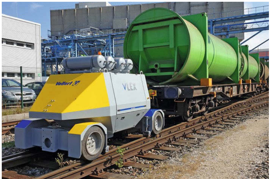
Abb. 15: Der neue Rangierer VLEX40 von Vollert bewegt innerbetrieblich, ferngesteuert und rein batterieelektrisch bis zu 600 t Last.
