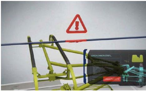
Abb. 1: Mit Hilfe des OnTrack Monitoring-Systems von Schunk lassen sich unter anderem Defekte an der Oberleitung zuverlässig lokalisieren, quantifizieren und überwachen. Visualisierung: Schunk
