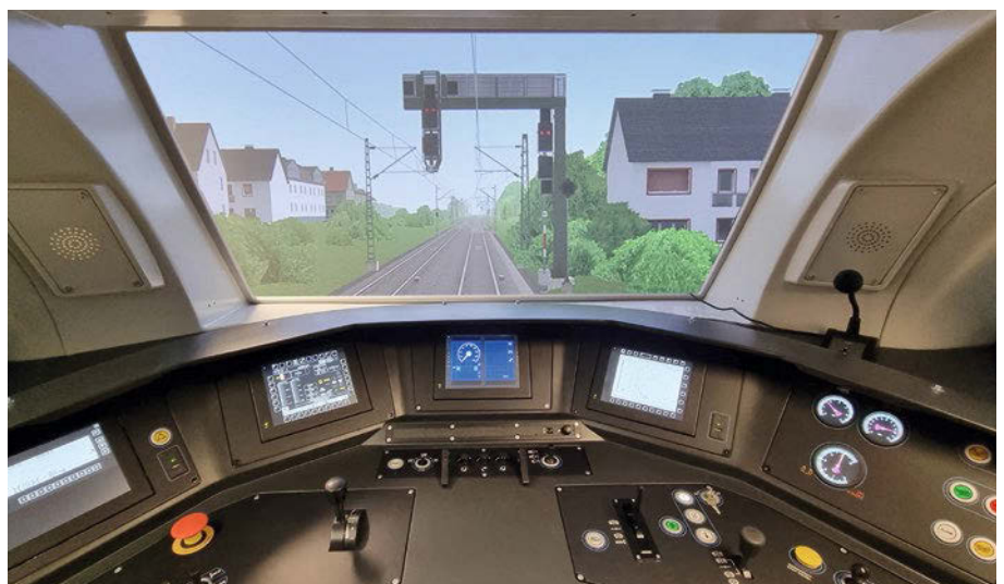
Abb. 2: Führerstand/Simulator für die Stadler Eurodual-Baureihe BR-159.
