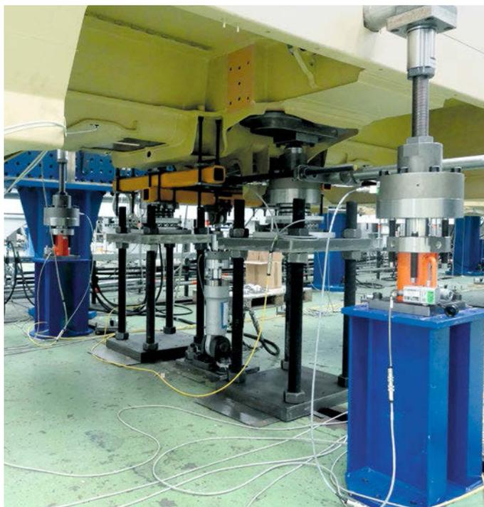
**Abb. 7:** Anhebestelle über Einschubbolzen
