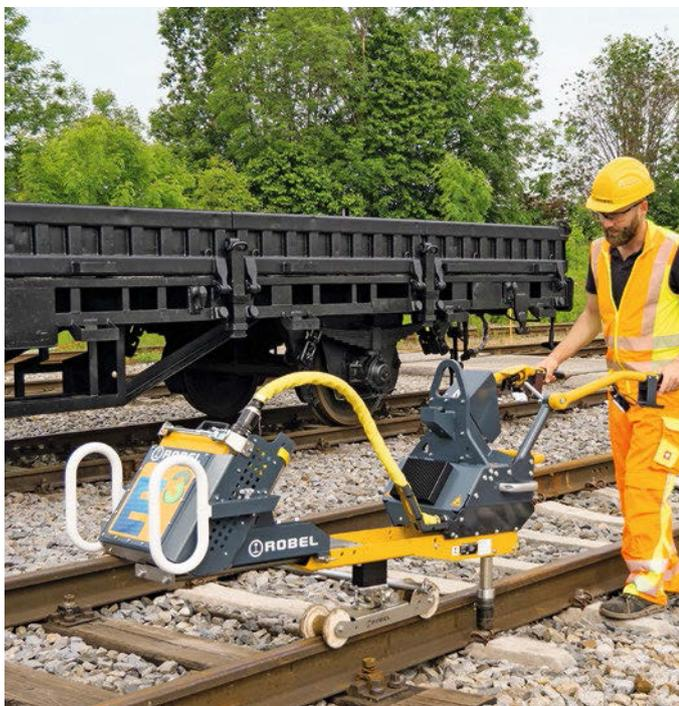
Vollelektrische, selbstlernende Präzisionsschraubmaschine Rowrench 30.76 E<sup>3</sup>
