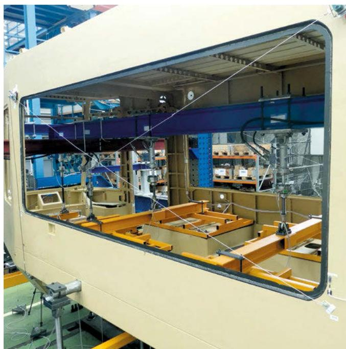
**Abb. 8:** Wegmessstellen Fensterdiagonalen und Lastgeschirre zur Einleitung der Fahrzeugzuladung
