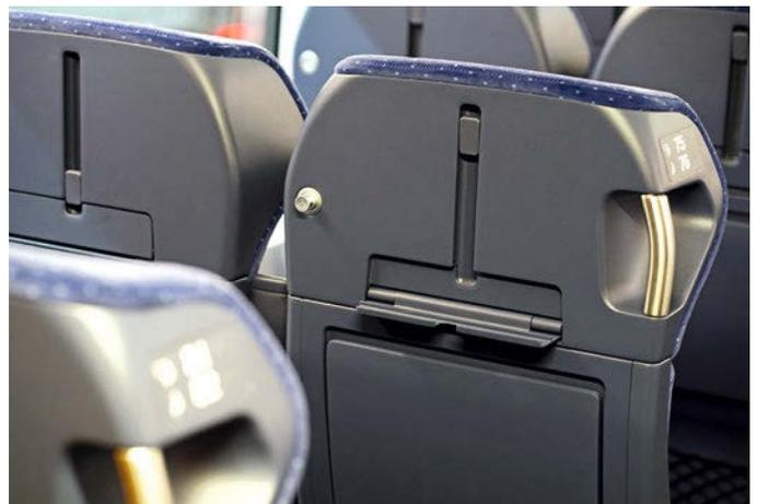
**Abb. 10:** Der neue Tablethalter im ICE 3neo
