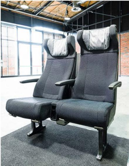
**Abb. 11:** Der Prototyp des neuen 2. Klasse-Sitzes, der ab dem 17. Zug eingebaut wird
