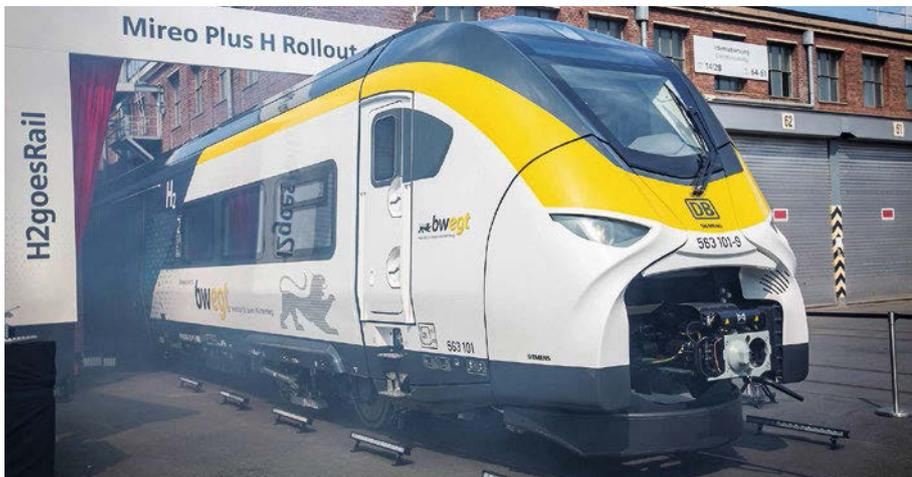
Der Mireo Plus H mit einem Antrieb über eine Brennstoffzelle und leistungsfähige Batterien.
