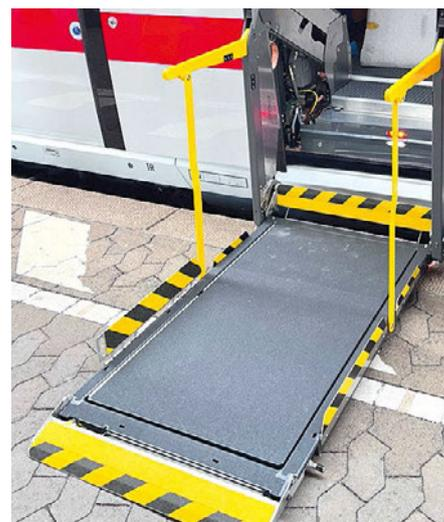
Abb. 6: Der neu konstruierte Hublift ist robuster und einfacher zu bedienen.
