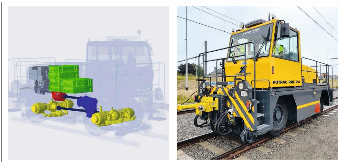
Das neue Zweiwege-Fahrzeug mit Batterieantrieb
