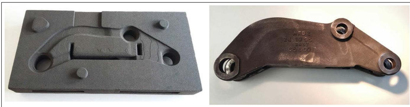
Abb. 4: Sandform, additiv gefertigt; Fertig-Gussteil aus additiv gefertigter Form
