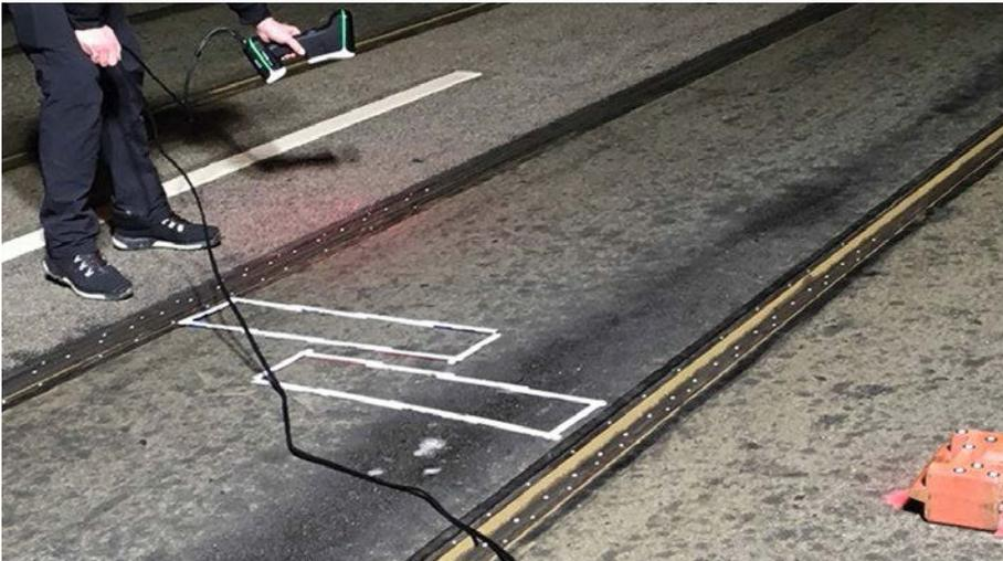
Abb. 4: Ermittlung der Gleisgeometrie Quelle: CE cideon engineering (Aufnahme während Messkampagne)
