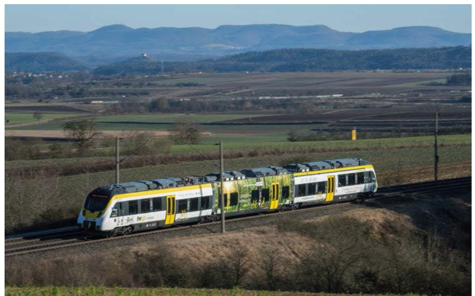
**3:** Der BEMU Demonstrator im Einsatz auf der Gäubahn im Batteriebetrieb unter der Oberleitung. Durch den Einsatz auf der elektrifizierten Strecke konnte auch der dynamische Traktionswechsel sowie die Nachladung der Traktionsbatterien während der Fahrt getestet werden
