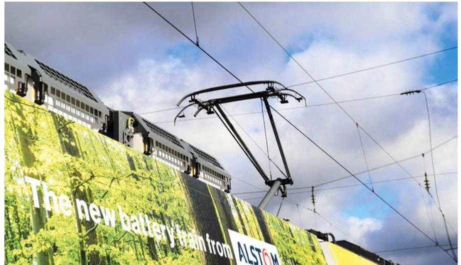
**2:** Blick auf zwei der insgesamt vier Traktionsbatteriesysteme. Die Nachladung wird über den Stromabnehmer im Stand und während der Fahrt unter der 15 kV, 16,7 Hz Oberleitung durchgeführt
