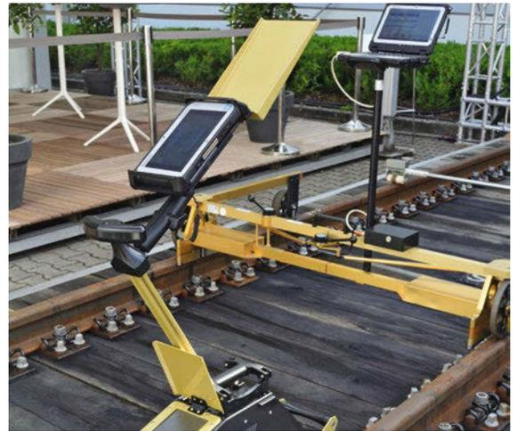
Oben: Vollelektrische, selbstlernende Präzisionsschraubmaschine Rowrench 30.76 E<sup>3</sup>; unten: RSCM Messgerät von Vogel & Plötscher
