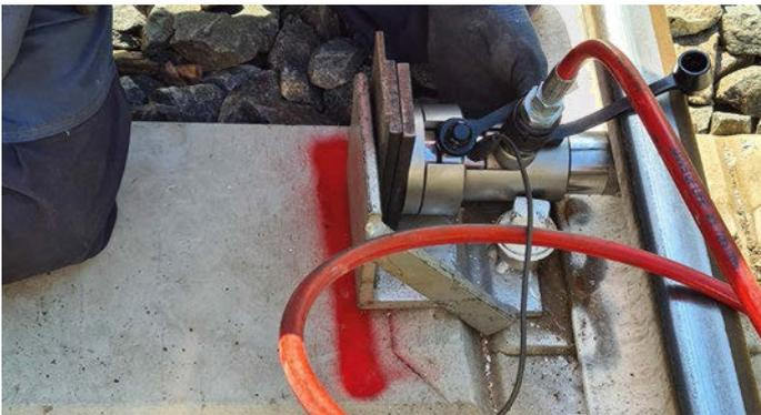
4: Verschiebeeinheit mit Druckzylinder und Kraftmessdose
