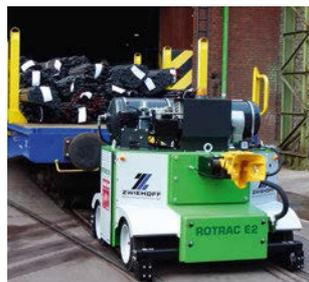
**ROTRAC E2** Elektro-Rangiergerät für Anhängelasten bis 250 t
