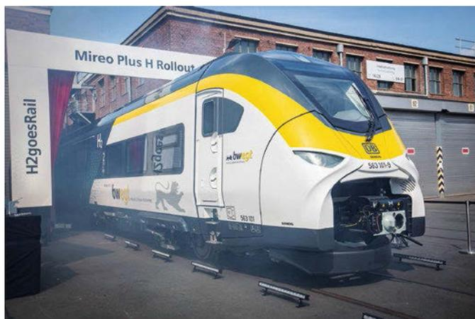
Der Mireo Plus H mit einem Antrieb über eine Brennstoffzelle und leistungsfähigen Batterien
