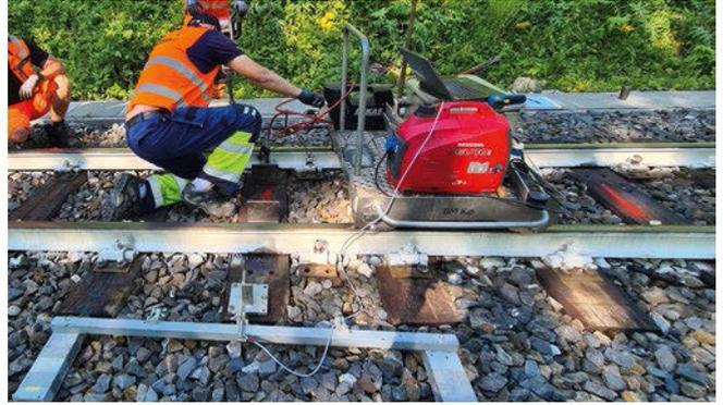
3: Ausrüstung zur Messung des Querverschiebewiderstandes
