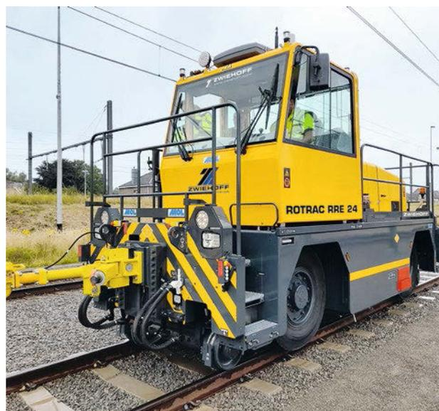
Das neue Zweiwege-Fahrzeug mit Batterieantrieb
