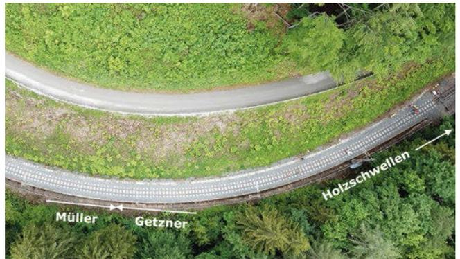
5: Lage der Versuchsschwellen im Bogen mit einer Besohlung von Müller und Getzner
