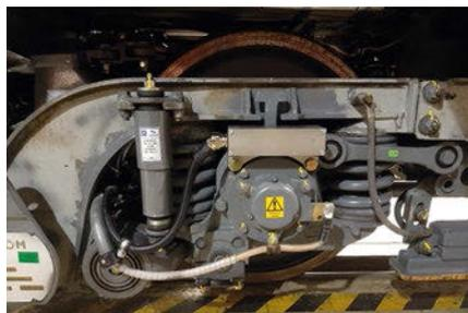
CTM-Technik zum Monitoring der Gleisgeometrie
