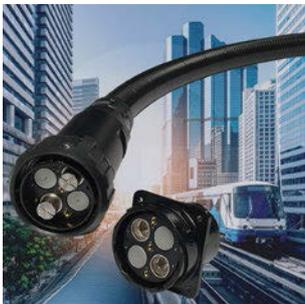
Modulare Steckverbinder von GIMOTA ermöglichen flexible Anschlussmöglichkeiten für Energie, Signale und Daten - auch unter extremen Umgebungsbedingungen wie zum Beispiel in Schienenfahrzeugen. Sie erfüllen die wichtigsten Bahnnormen wie R22, R23 / HL1, HL2, HL3 der EN 45545-2, IP65 / IP67 und IP69 (Hochdruckreinigung) nach DIN EN 60529 und Kategorie 2 (Drehgestellmontage) Schock- und Vibrationstest der EN 61373.
