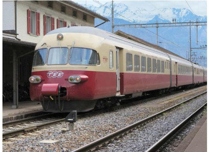
**3:** Einmal der Traum eines jeden Fernreisenden! Einer der fünf zwischen 1961 und 1966 erbauten TEE II der SBB. Mit ihren vier Stromsystemen waren sie europaweit einsetzbar! Die Außerbetriebnahme erfolgte zwischen 1959 und 2000. Die Höchstgeschwindigkeit von 160 km/h beeindruckt heute jedoch niemand mehr
