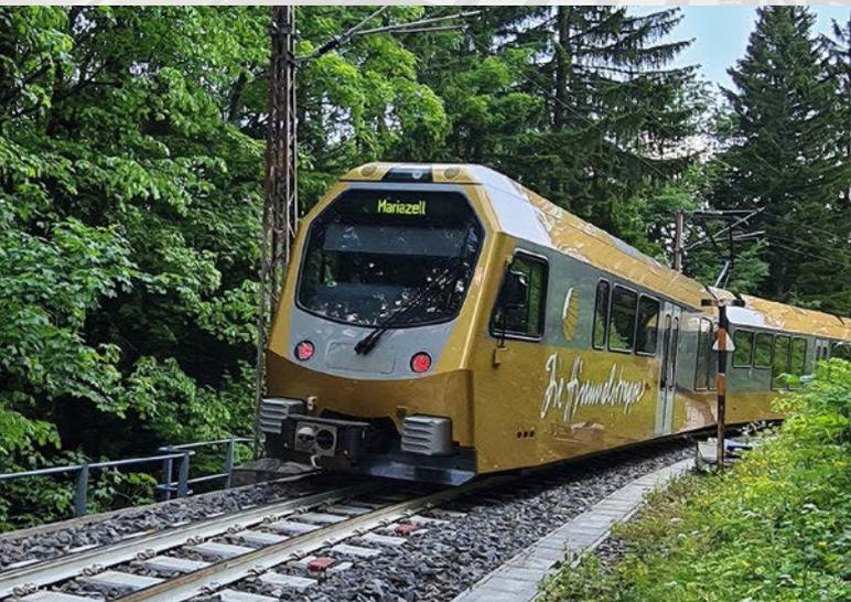
Verwerfungssichere durchgehend verschweißte Schmalspurgleise bei der Mariazellerbahn **136**
