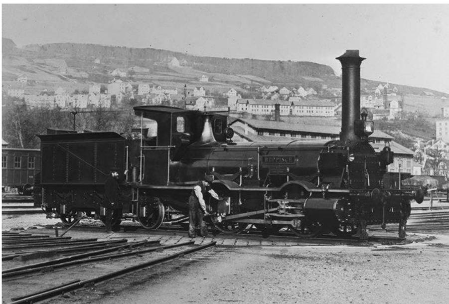
**1:** Auf der Drehscheibe der Werkstätte Zürich, die Güterzugslokomotive mit Stütztender D 2/2 Reppisch mit Baujahr 1863. Die beiden ersten Loks lieferte die Maschinenfabrik Escher, Wyss & Cie. in Zürich, die restlichen vier, so auch die Reppisch, die Maschinenfabrik Esslingen an die Zürich-Zug-Luzernbahn. Die Lok war nach deren Übernahme noch bei der Schweizerischen Nordostbahn bis 1876 in Betrieb
