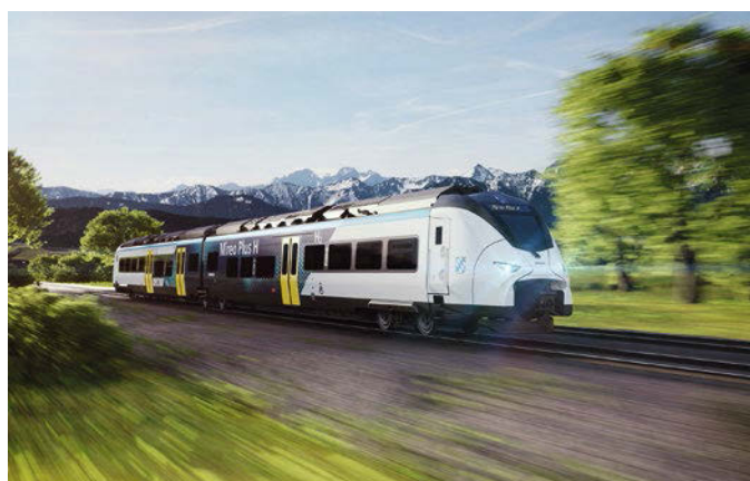
Abb. 6: Wasserstofftanks und Brennstoffzelle auf dem Dach unterscheiden den Mireo Plus H von seinen anderen elektrischen Brüdern.
