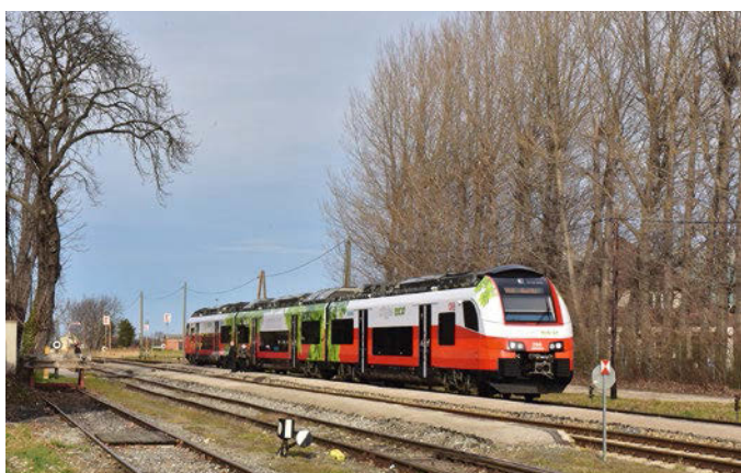
Abb. 5: Elektrisch, aber keine Oberleitung: Der Cityjet eco der ÖBB auf der Aspangbahn zwischen Wien und Wiener Neustadt.
