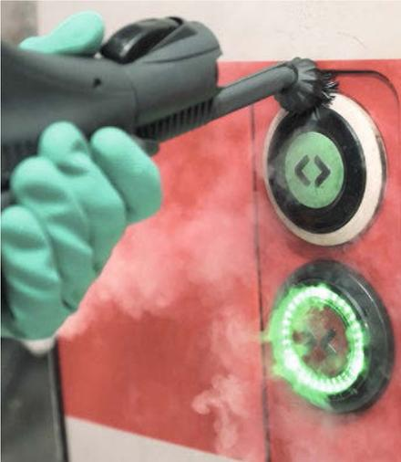
**Abb. 7:** Manuelle Reinigung eines ICE 4 mit der Padreinigung *Quelle: DB AG/Nico Söldner*
