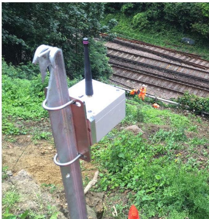
Abb. 8: Böschungsüberwachung mittels Neigungssensoren
