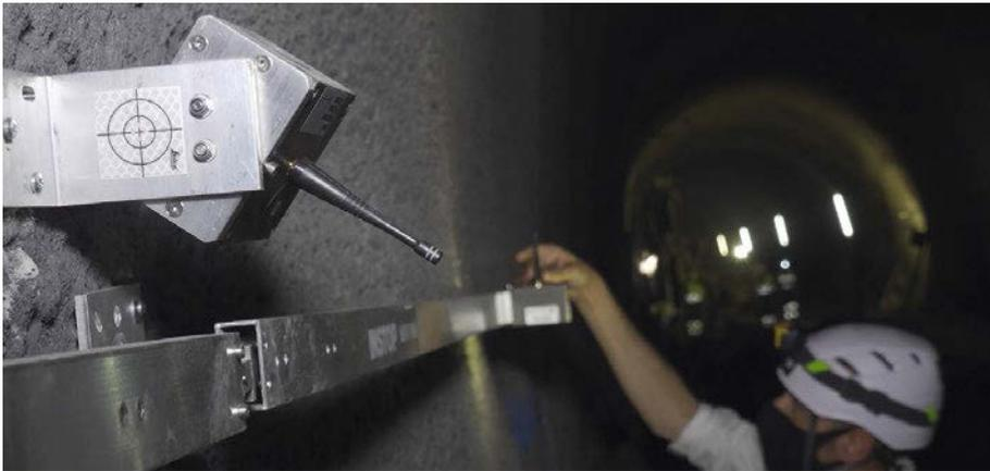
**Abb. 4:** Laserdistanzsensor zur Überwachung von 1D-Konvergenzen; 3-Achs-Technik erlaubt die Beobachtung von Neigungsänderungen ohne Vorhorizontierung.
