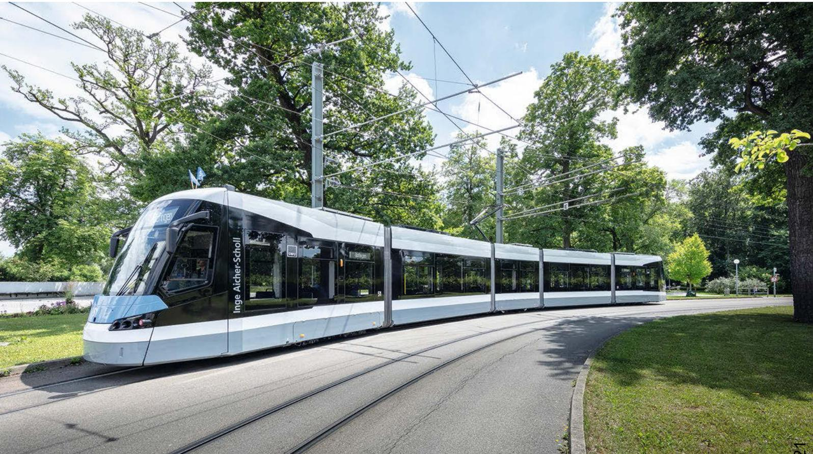
**Abb. 1:** Für Niederflurbahnen wie die Serie Avenio (Bild) oder S70 von Siemens hat SGF Antriebskupplungen entwickelt, die 50 % länger halten als marktübliche Kupplungen mit Gummielementen. Quelle: Siemens AG
