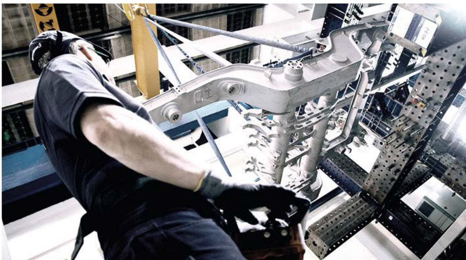
**Abb. 1:** Auf 13 Prüfständen und einer Prüffläche von über 3000 m<sup>2</sup> werden Lauf- und Triebdrehgestelle getestet.
