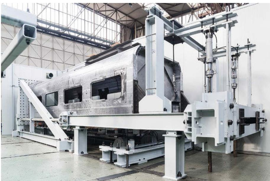
**Abb. 2:** Auf drei separaten Testgleisen prüft die IMA Dresden die Festig- und Belastbarkeit von Wagenkästen.
