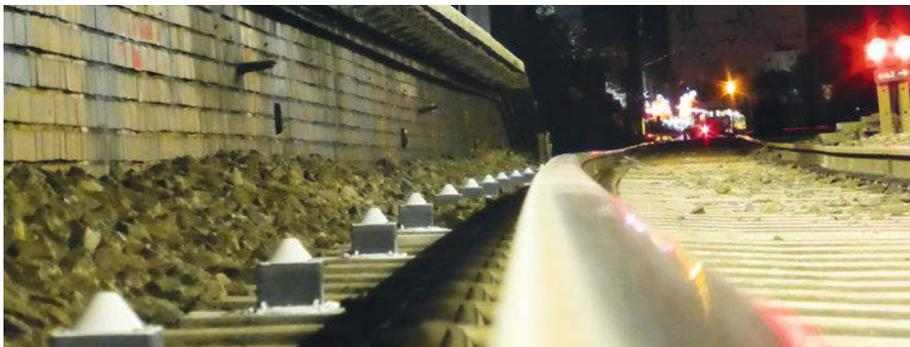
Abb. 1: 3-Achs-Neigungssensoren im Einsatz bei der Gleisüberwachung Quelle aller Abb.: Senceive LTD
