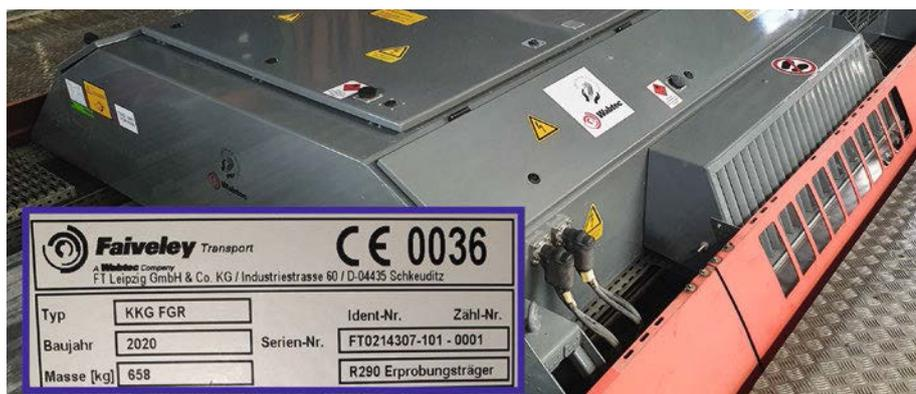
Abb. 5: Aufdachklimaanlage mit dem Kältemittel R290 auf einem Nahverkehrsfahrzeug
