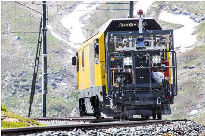
Mit modernster Technologie wie etwa 5G, Cloudlösungen oder auch Data Analytics unterstützen die Rhomberg Sersa Rail Group und Swisscom die „digitale Baustelle“. Im Bild ein Messwagen-Prototyp, mit dem die Gleisinfrastuktur während der Fahrt auf den Millimeter genau vermessen werden kann
