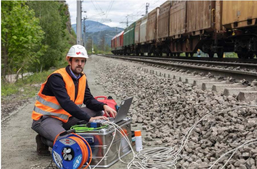
2: Gleismessung von Schienenfußspannungen mittels DMS
