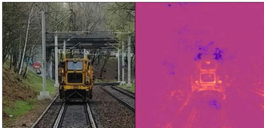
3: SRA angewandt auf ein auf dem IMAGENET-Datensatz trainiertes Modell bei einem Bild eines Straßenbahn-Zweiwegefahrzeugs. Gelbe Bereiche haben eine positive, grüne eine neutrale und blaue eine negative Relevanz
