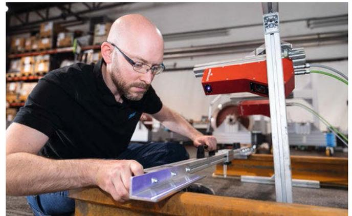
Erfassung von Schienenprofilen mittels Lasertechnik
