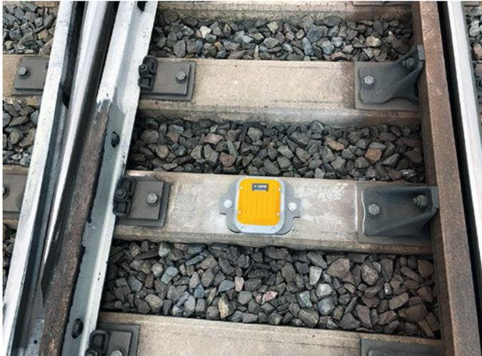
**3:** Sensorboxen messen an den Betonschwellen Vibrationen und Temperaturen
