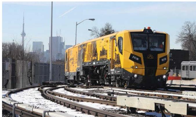
Die neue LINSINGER Fräsmaschine SF02T-FS ist mit der modernsten und leistungsfähigsten Generation diesel-elektrischer Fräsaggregate ausgestattet und kann alle von TTC geforderten Profile bearbeiten. Durch die niedrige Bauweise
