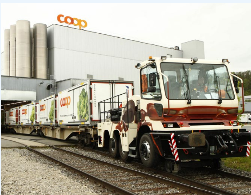
In Aclens/Vufflens-la-Ville rangiert ein Zweiwegfahrzeug des EVU RailCare die Tragwagen mit Wechselbehältern des Einzelhändlers Coop.
