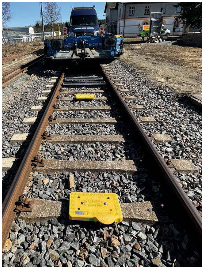
Bild 5: ETCS L3-Testbalisen im Testfeld Bahnhof Scheibenberg, Strecke Annaberg-Buchholz – Schwarzenberg
