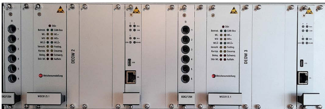
Bild 5: Kernzeile Rechnersystem Weichensteuerung des digitalen EOW-Systems
