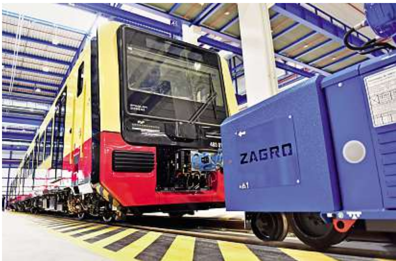
In dem neuen Fertigungskomplex von Stadler Deutschland in Berlin werden die neu zusammengestellten Züge batterieelektrisch verschoben.
