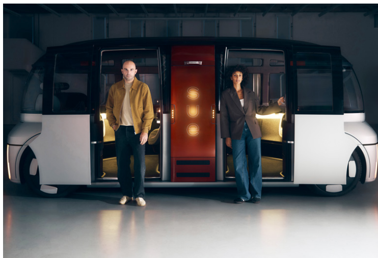
Abb. 1: SUE – der vollelektrische People Mover: Das straßenzugelassene Fahrzeug wurde vollständig in Deutschland entwickelt, von der 48-Volt-Skateboard-Plattform über das Design bis hin zur autonomen Software. Foto: UE I Studios/ Maximilián Balázs
