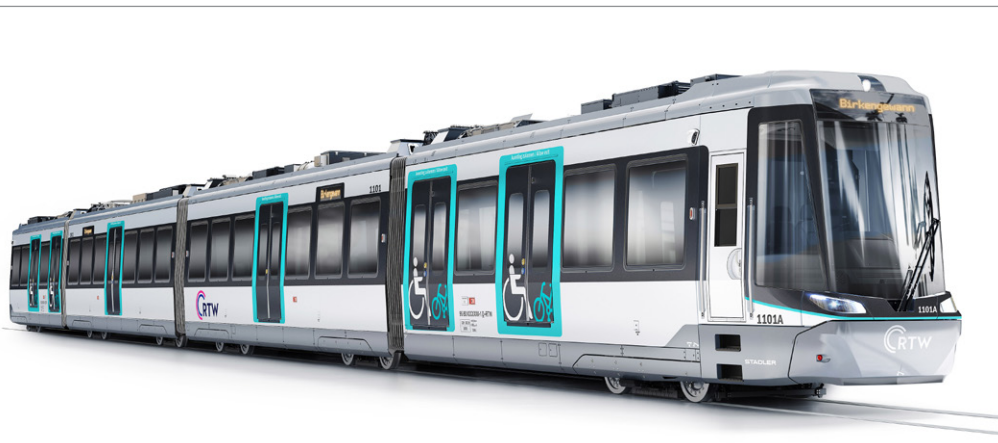
Abb. 10: Für gleiche Bahnsteighöhen ausgelegt werden die Citylink von Stadler für das Projekt Regionaltangente West: für 76 und 96 cm hohe Bahnsteige im Netz der Deutschen Bahn und 80 cm hohe RTW-eigene Stationen. Insgesamt 27 Fahrzeuge wurden geordert. Fotos: Stadler
