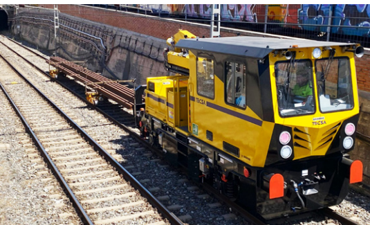
Abb. 5: Batterieelektrisch fahrendes Hybrid-Arbeitsfahrzeug im Einsatz bei der Metro Madrid.
