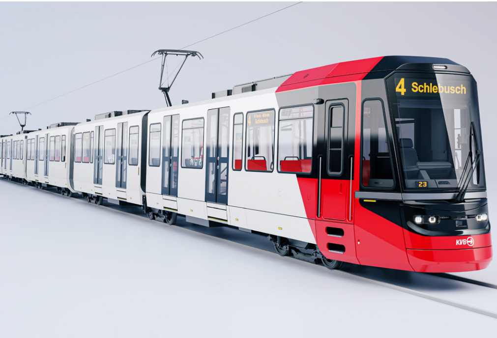
Abb. 11: Bis zu 60 m lange Zugeinheiten können die Kölner Verkehrs-Betriebe mit den neuen Hochflurbahnen von Stadler bilden. Der Auftrag umfasst 132 zweiteilige Fahrzeuge, die Heck-an-Heck gekuppelt zum Einsatz kommen. Zudem umfasst der Auftrag 34 je 10 m lange Zwischenwagen, die in Kombination so die Länge von 60 m erreichen.
