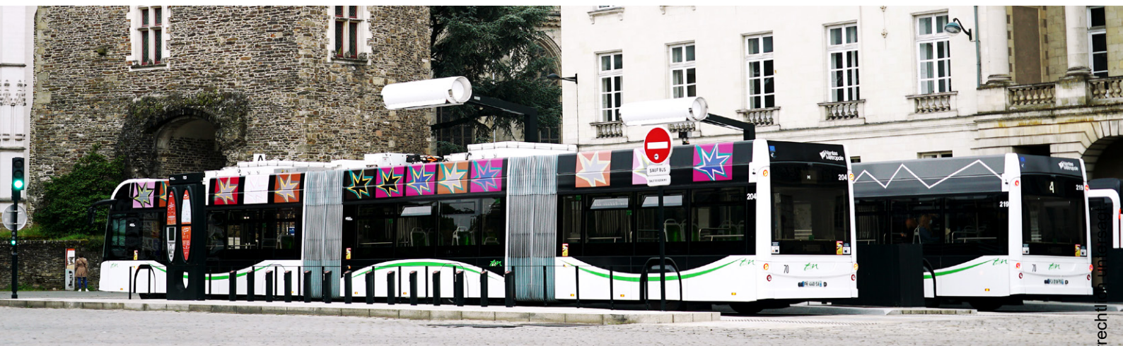
Abb. 1: Flash-Charging in Nantes: Nachladung während des Betriebs ermöglicht die Elektrifizierung anspruchsvoller Buskorridore mit Doppelgelenkbussen.
