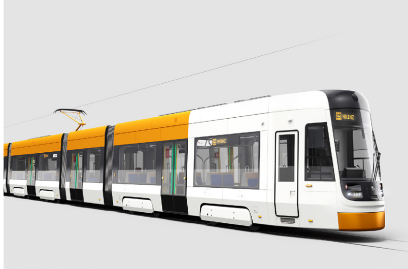
Abb. 8: Mit 43,5 m werden sie künftig die längsten Straßenbahnen in Mainz sein, die 22 bei Škoda bestellten Niederflurbahnen. Die zuletzt von Stadler gelieferten sind hingegen nur 30 m lang. Und während es sich bei Stadler-Bahnen um Einrichtungsfahrzeuge handelt, sind die tschechischen Fahrzeuge Zweirichtungsbahnen.
