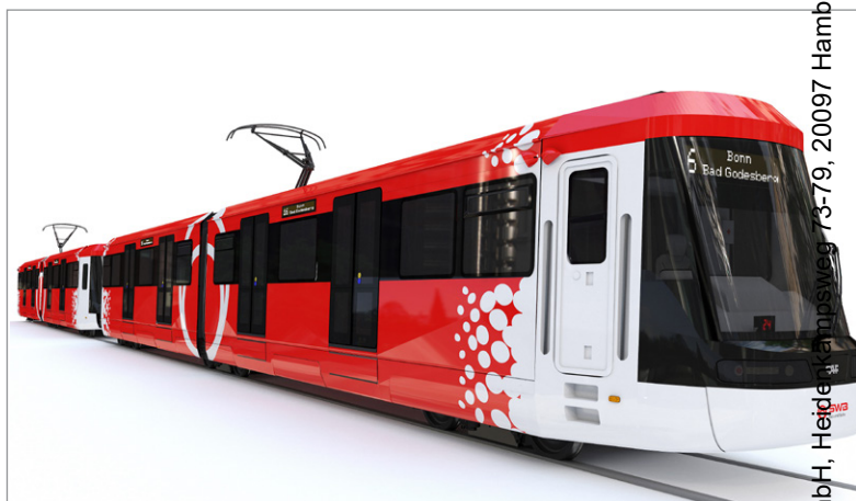
Abb. 3: Je 16 hochflurige Stadtbahnwagen liefert CAF an die SWB und die SSB. Sie erhalten nur einen Führerstand, kommen also immer Heck-an-Heck gekoppelt in den Linienverkehr.
