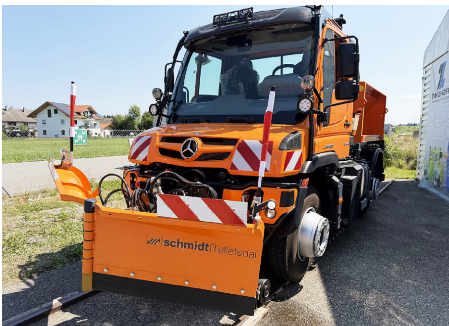
Abb. 9: Die vier Multifunktionsfahrzeuge für die SWM München sind für Ganzjahreseinsatz (Netzinstandhaltung und Winterdienst) bei der Tram München mit Sonderaufbauten versehen und von Zwiehoff mit Zweibege-Einrichtungen ausgerüstet.
