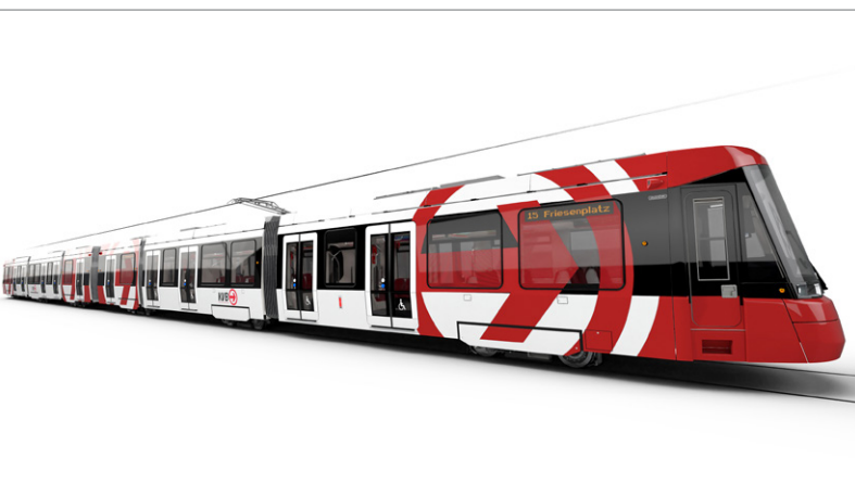
Abb. 2: 60 m lang und durchgehend begehbar sind die 62 von den Kölner Verkehrs-Betrieben bei Alstom bestellten Citadis-Niederflurbahnen. Die Order umfasst zusätzlich zwei 30 m-Fahrzeuge, die damit 90 m-Zugverbände ermöglichen können.
