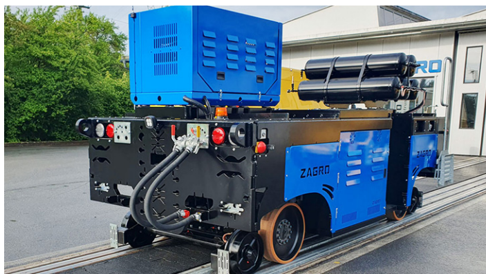
Abb. 6: Elektro-rangierfahrzeuge des Typs Zagro E-MAXI finden insbesondere in Werkstätten international ein weites Betätigungsfeld.
