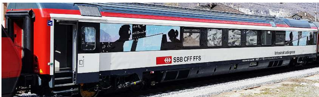
Abb. 3: Das gDFZ (gezoogenes Diagnosefahrzeug), eines der vier Fahrzeuge mit RCM-System, im Einsatz seit 2019. Aufgenommen während einer Testfahrt, südlich vom Gotthard-Basistunnel.
