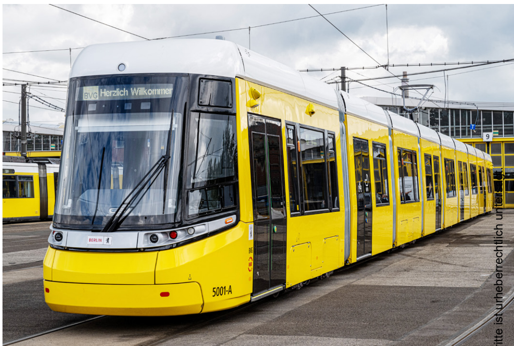
Abb. 1: Der Urbanliner, mit 50 m die längste Straßenbahn in Berlin. Er ist seit Juli 2026 auf der Linie M4 im Einsatz und ersetzt dort insbesondere Doppeltraktionen, zwei je 26,8 m lange Bahnen aus den neunziger Jahren. Insgesamt wurden bisher 65 Einheiten bestellt.
