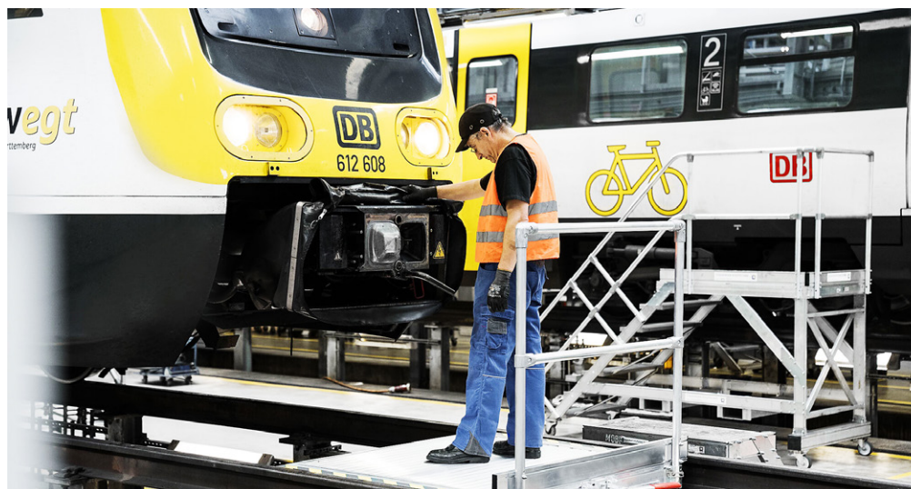
Abb. 10: Das Gleispodest erleichtert den Werkstattteams Wartungsarbeiten am Zug.
