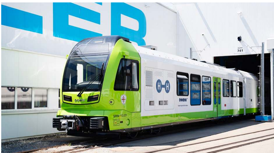
Abb. 8: Weltneuheit ist der Wasserstoffzug für Südtalien, mit dem emissionsfreier Betrieb auf nicht elektrifizierten Meter- und Schmalspurstrecken möglich wird.
