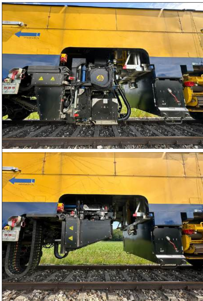
Abb. 2: Nach innen schwenkbare Fräseinheit zur Erhöhung des Arbeitsschutzes
