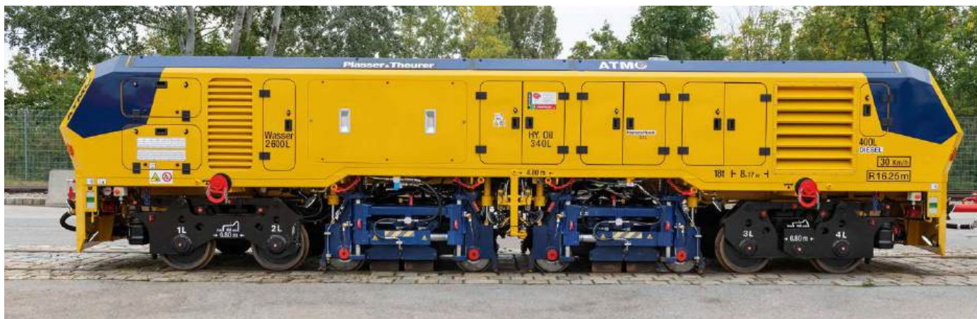
Abb. 2: ATMO (Automated Track Machine Oscillator) – Fahrzeug zur präventiven Schienenpflege
