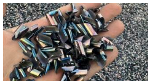
Abb. 10: Die beim Fräsen anfallenden Späne werden in einem Behälter gesammelt, um als Stahl wiederverwendet zu werden.
