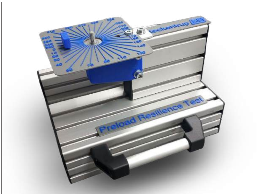
Abb. 4: Prüfaufbau des Preload-Resilience-Tests mit Kraftmessung
