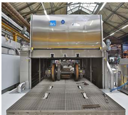
Großteilwaschanlage Pacific zur automatisierten Reinigung von Radsätzen
