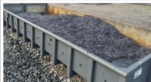
Abb. 10: Die beim Fräsen anfallenden Späne werden in einem Behälter gesammelt, um als Stahl wiederverwendet zu werden.
