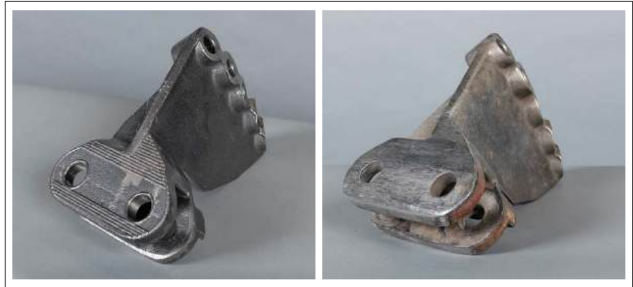
Abb. 4: Kratzerschaufel unverschlissen versus verschlissen – Geometrieänderung als Ursache veränderter Lastverteilung
