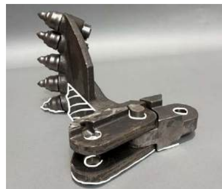
Abb. 3: Räumkette – tribologische Zonierung nach Schaufelblatt, Kratzerfingern, Führungsflächen, Bolzen und Gelenken
