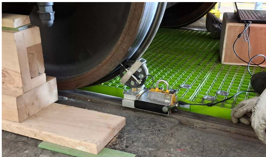
4: Erfassung der Radrauheit am Erprobungsträger
