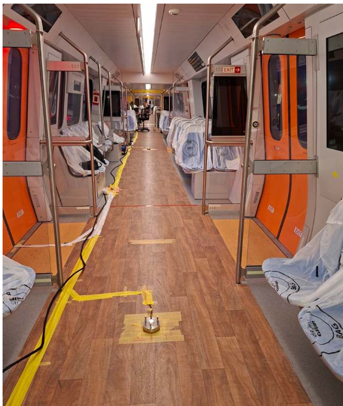
3: Typische Versuchsdurchführung zur Bestimmung des Fahrkomforts (links: am Fahrzeugboden befestigte Beschleunigungssensoren ASC OS-315LN-PG, rechts: mit Ballastierung zur Simulation der Fahrgäste)
