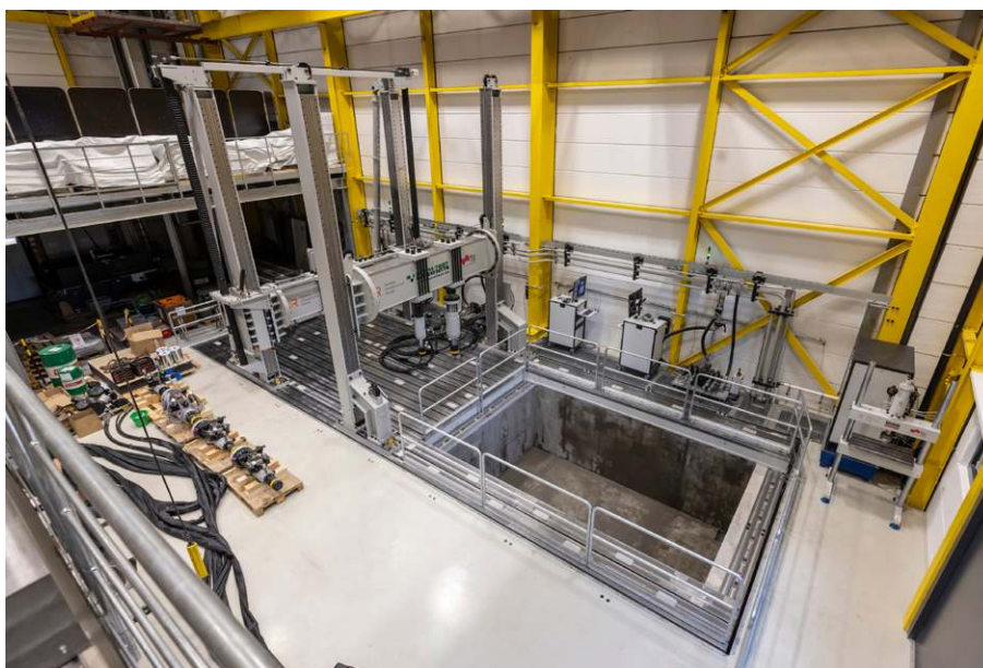
1: Railway and Infrastructure Laboratory (RaIL) der TU Graz: neue großmaßstäbliche Prüfumgebung für Untersuchungen an Oberbau- und Unterbausystemen Quelle: Lunghammer/TU Graz
