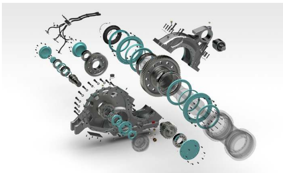
3: Explosionsdarstellung eines Bahngetriebes mit den wesentlichen Baugruppen
