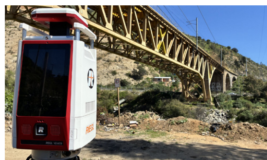
Kompakt, leicht und vielseitig: terrestrischer Laserscanner VZ-600i Quelle: Riegl
