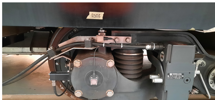
2: Beschleunigungssensoren ASC OS-115LN-PG am Achslager und Drehgestellrahmen zur Prüfung der fahrtechnischen Eigenschaften einer U-Bahn
