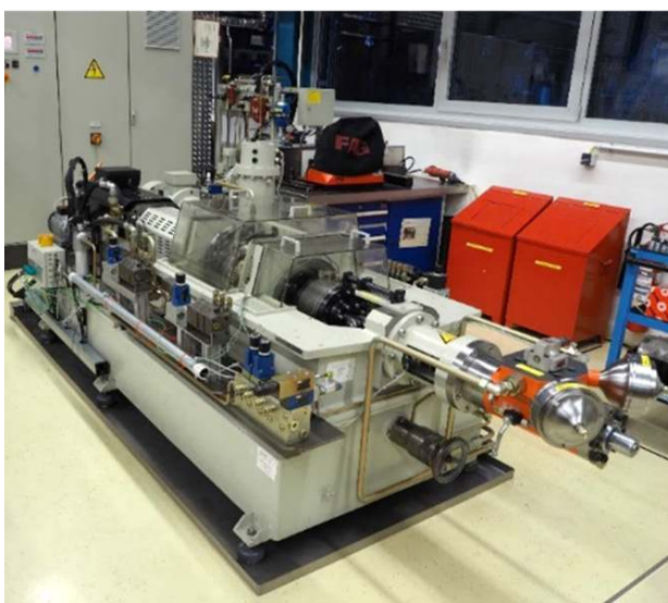
3: links: klassische Reibungswaage R6; rechts: Reibungswaage für fettgeschmierte Radsatzlager R32
