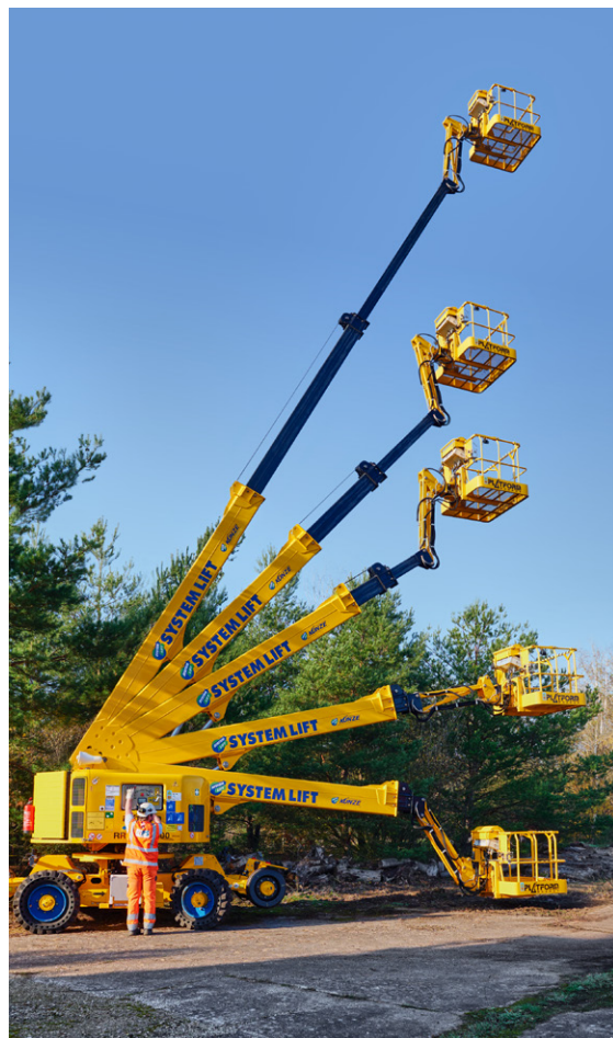
Die RR 19-Arbeitsbühne für große Höhen und mit 500 kg Korblast Quelle: Kunze
