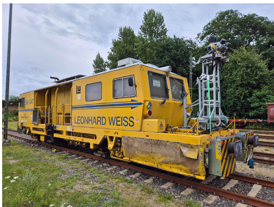
2: Das verwendete, auf einem aufgebauten Gestell montierte MX-9 Sensorsystem
