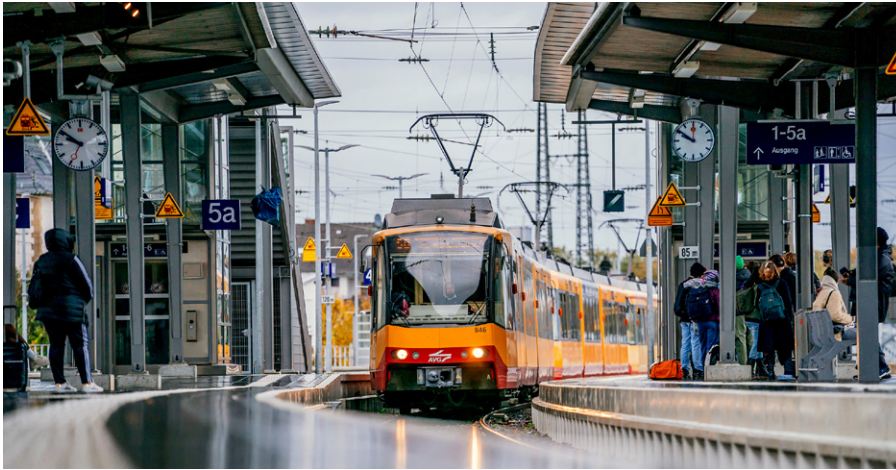
4: Zweisystem-Stadtbahnen auf Eisenbahninfrastruktur in Rastatt Quelle: Deutsche Bahn AG/Thomas Niedermüller
