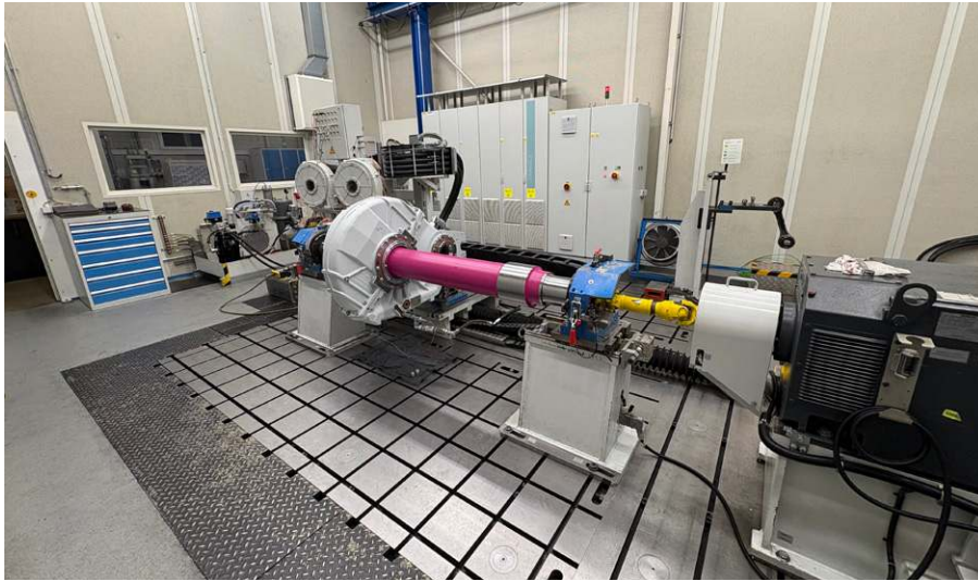
5: Prüfstand zur Lastprüfung von Bahngetrieben
