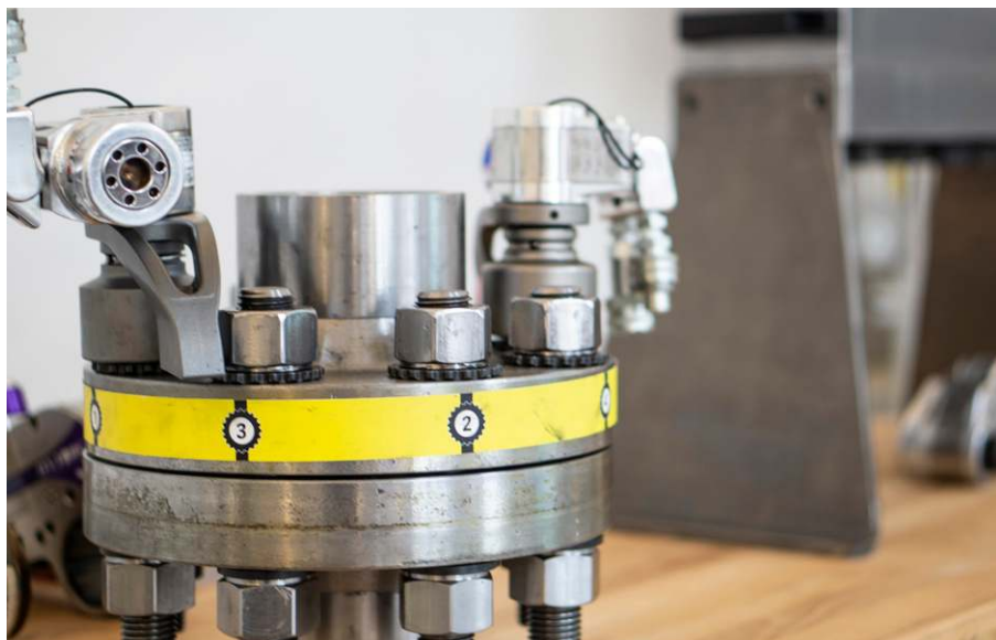
1: Die neue DIN EN 17976 legt fest, dass für jede Schraubverbindung ein Sicherheitsbedürfnis festzulegen ist
