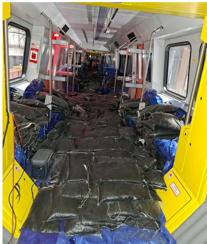
3: Typische Versuchsdurchführung zur Bestimmung des Fahrkomforts (links: am Fahrzeugboden befestigte Beschleunigungssensoren ASC OS-315LN-PG, rechts: mit Ballastierung zur Simulation der Fahrgäste)
