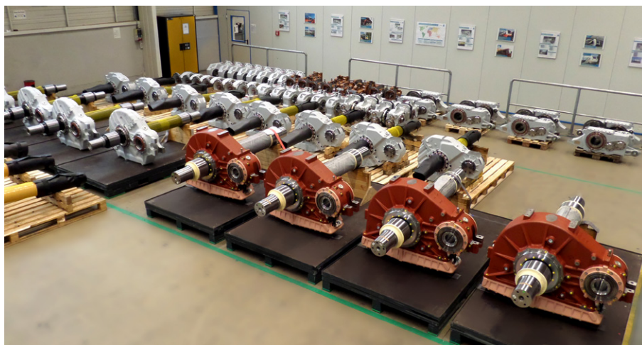
4: Getriebevarianten für alle Arten von Schienenfahrzeugen, von Straßenbahnen bis hin zu Hochgeschwindigkeitszügen und Lokomotiven
