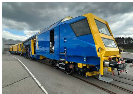
Die von system7 gebaute Stopfmaschine, die zeitnah an Spitzke übergeben werden soll Quelle: Spitzke
