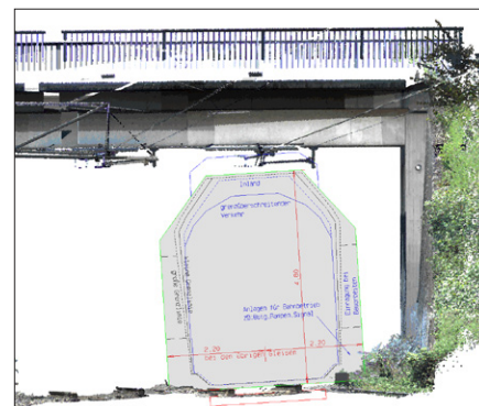
Systemseitiger Nachweis der Lichtraumprofilfreiheit im Rahmen einer Kollisionsprüfung Quelle: Geo Digital
