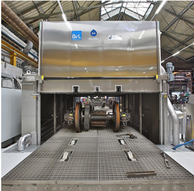
Großteilwaschanlage Pacific zur automatisierten Reinigung von Radsätzen Quelle: BvL Oberflächentechnik
