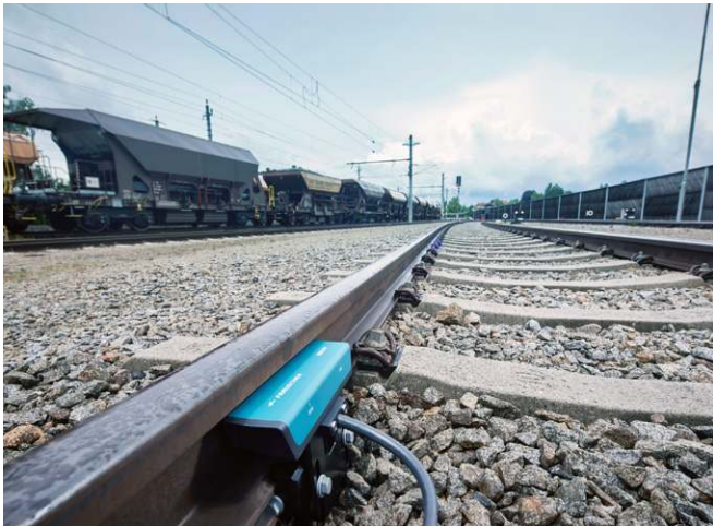
Bild 7: Der Frauscher Radsensor RSR310 wird mittels patentierter Schienenklaue am Gleis montiert.
