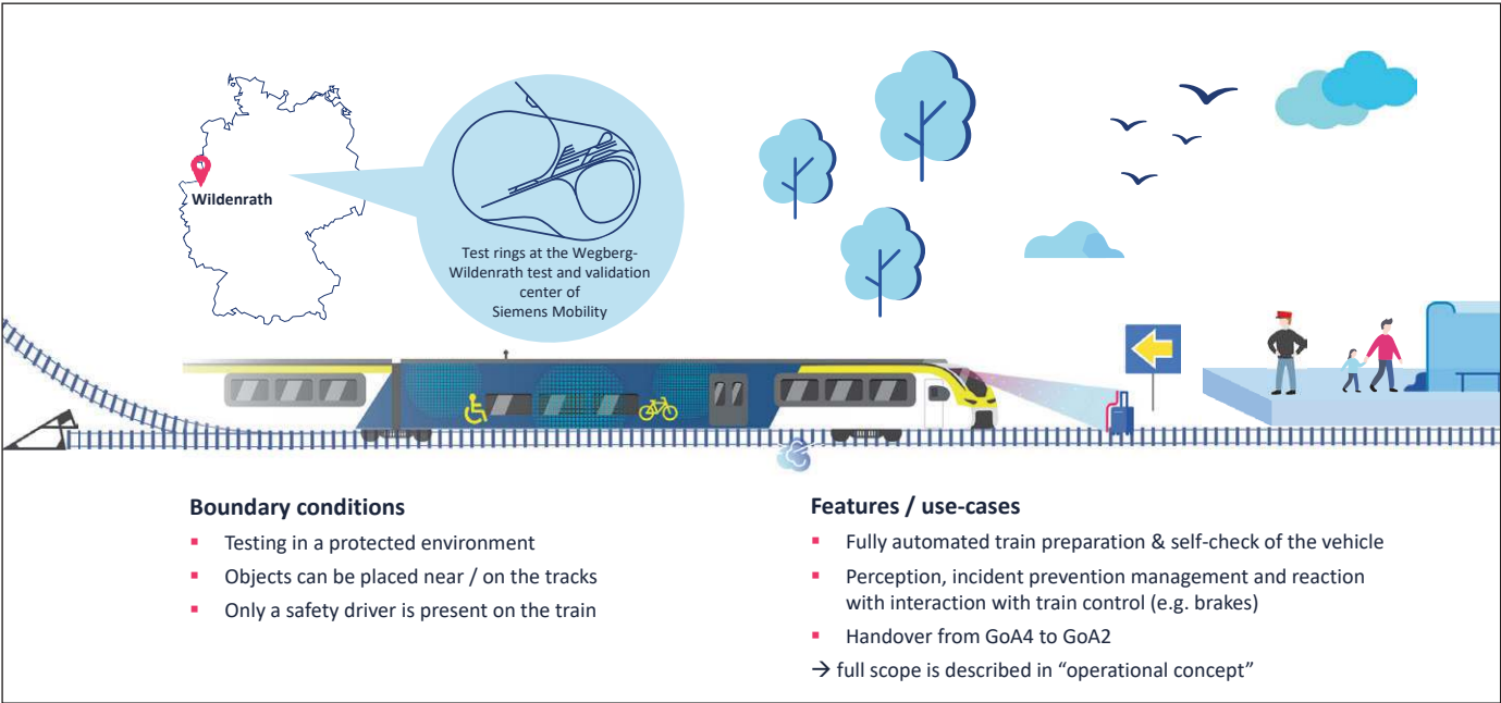
Bild 6: Testumgebung und Scope des Siemens Mireo Fig. 6: The test environment and scope for the Siemens Mireo
