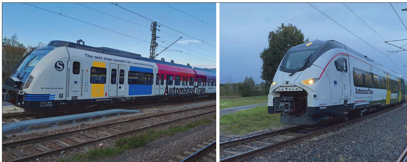
Bild 4: Die beiden im Projekt umgebauten Triebzüge, BR430 der S-Bahn Stuttgart (links) und Mireo der Firma Siemens Mobility (rechts)
