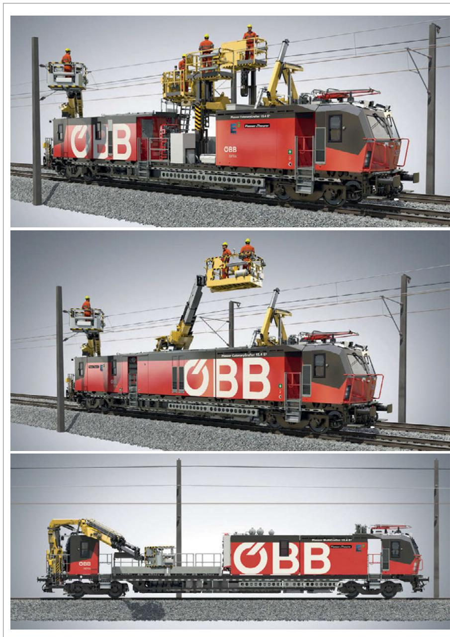
Abb. 1: Neue Fahrzeugflotte, Typ 1–3 mit unterschiedlichen Maschinenlayouts.
