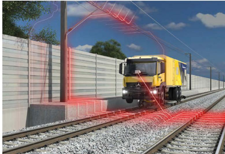
Abb. 10: Lichtraumprofilmessung mit dem Plasser InfraSpector Truck.
