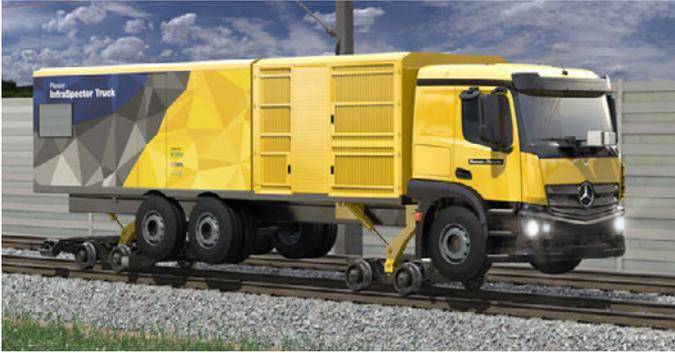
Abb. 1: Der Plasser InfraSpector Truck bewegt sich autonom auf Straße und Schiene und dient am Gleis als Prüflabor. Foto: Plasser & Theurer
