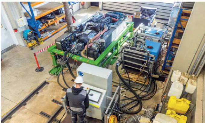
Abb. 3: Powerpack am Prüfstand.
