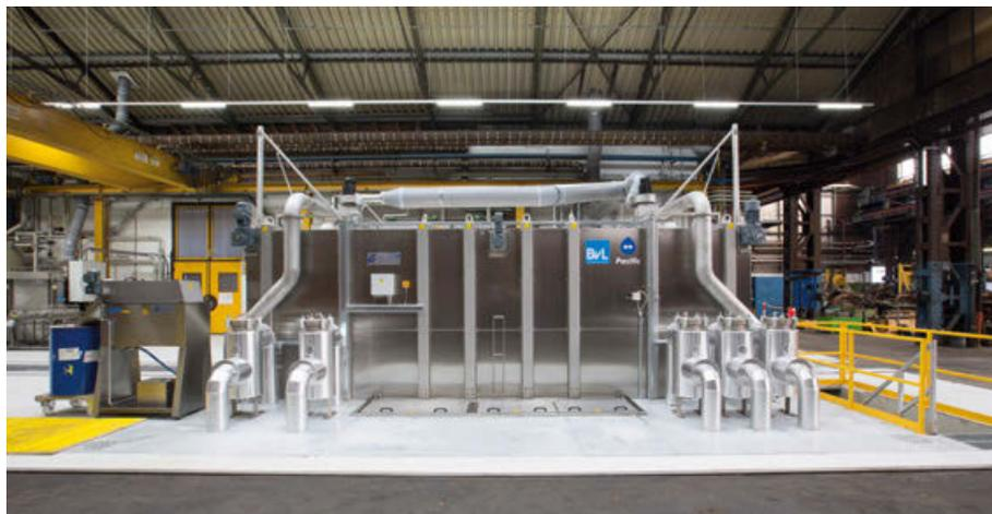
Abb. 6: Moderne Großteile-Reinigungsanlage Pacific von BvL zur Reinigung von Drehgestellen und Radsätzen. Foto: BvL Oberflächentechnik
