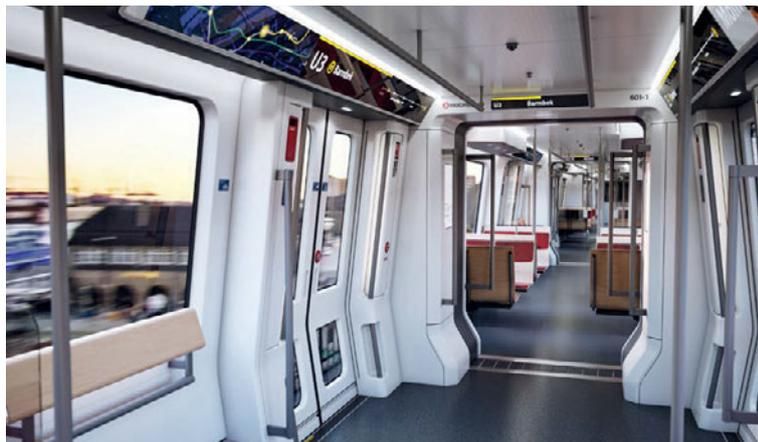
Abb. 2: Neues Innenraumkonzept mit mehr Transparenz durch Glas-türen. Ein erleichterter Zugang und bessere Durchgängigkeit sollen den Fahrgastfluss verbessern.
