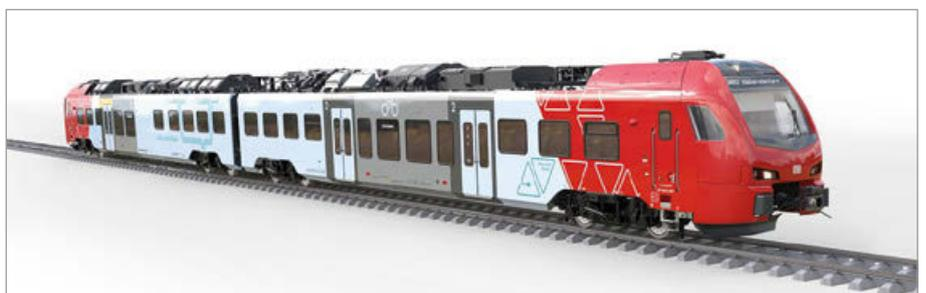
Abb. 4: Triebzug FLIRT Akku von Stadler in der batterieelektrischen Variante.
