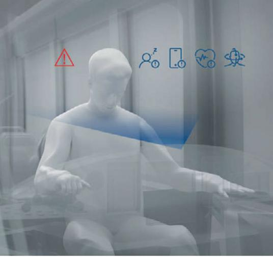
Abb. 4: Der Tram Focus Assist analysiert die Blickrichtung, Mimik und Haltung des Fahrers und erkennt beispielsweise Müdigkeitssignale oder Ablenkung vom Verkehrsgeschehen und warnt den Fahrer entsprechend.
