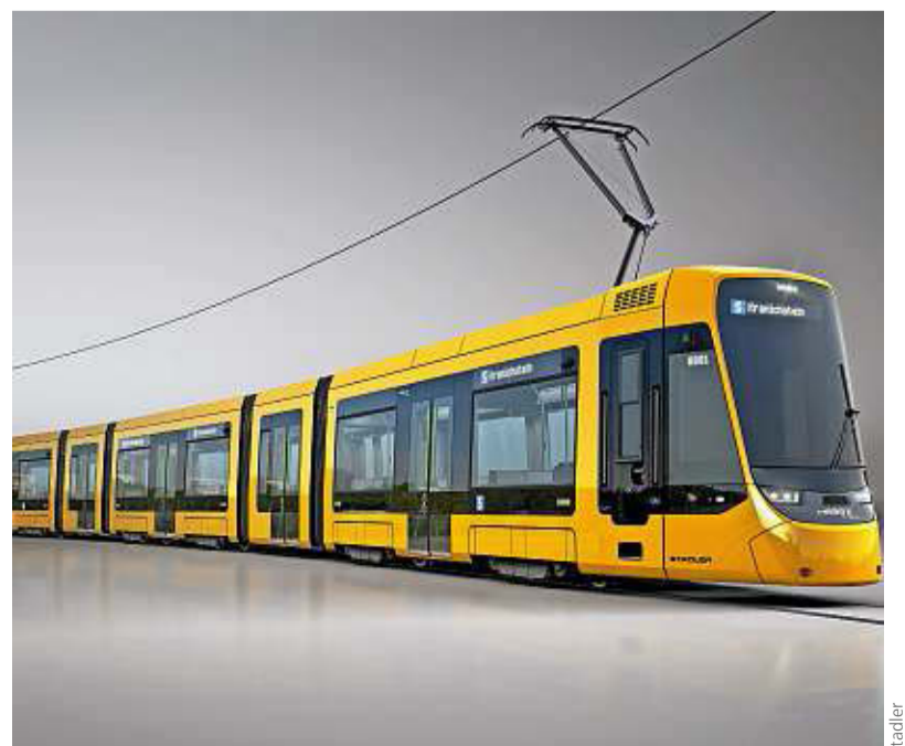
Zu sehen sein wird die im Fahrgastraum komplett podest- und stufenfreie Niederflurstraßenbahn „TINA“ von Stadler für die HEAG Darmstadt.
