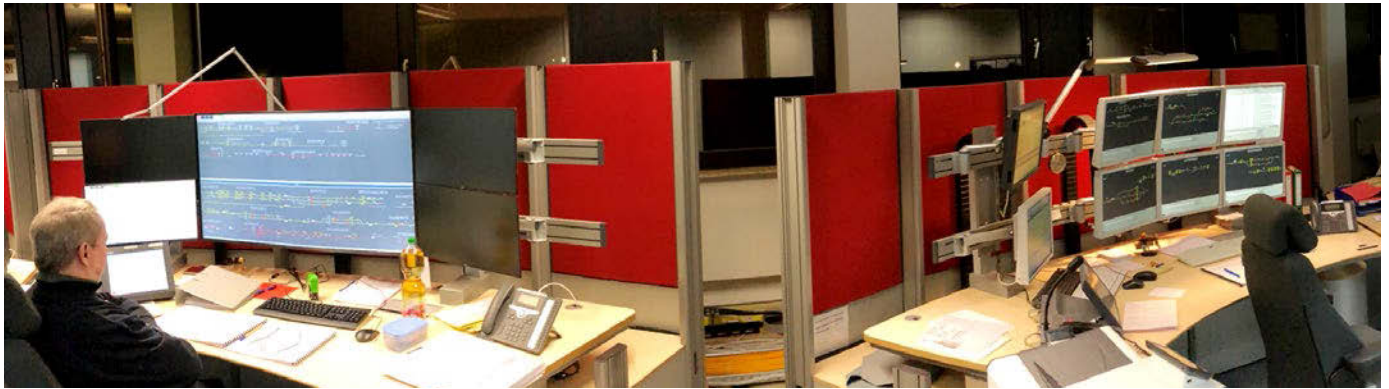
Bild 2: RBZ Göttingen mit iBS in Betrieb – rechts der „alte“ Bedienplatz
