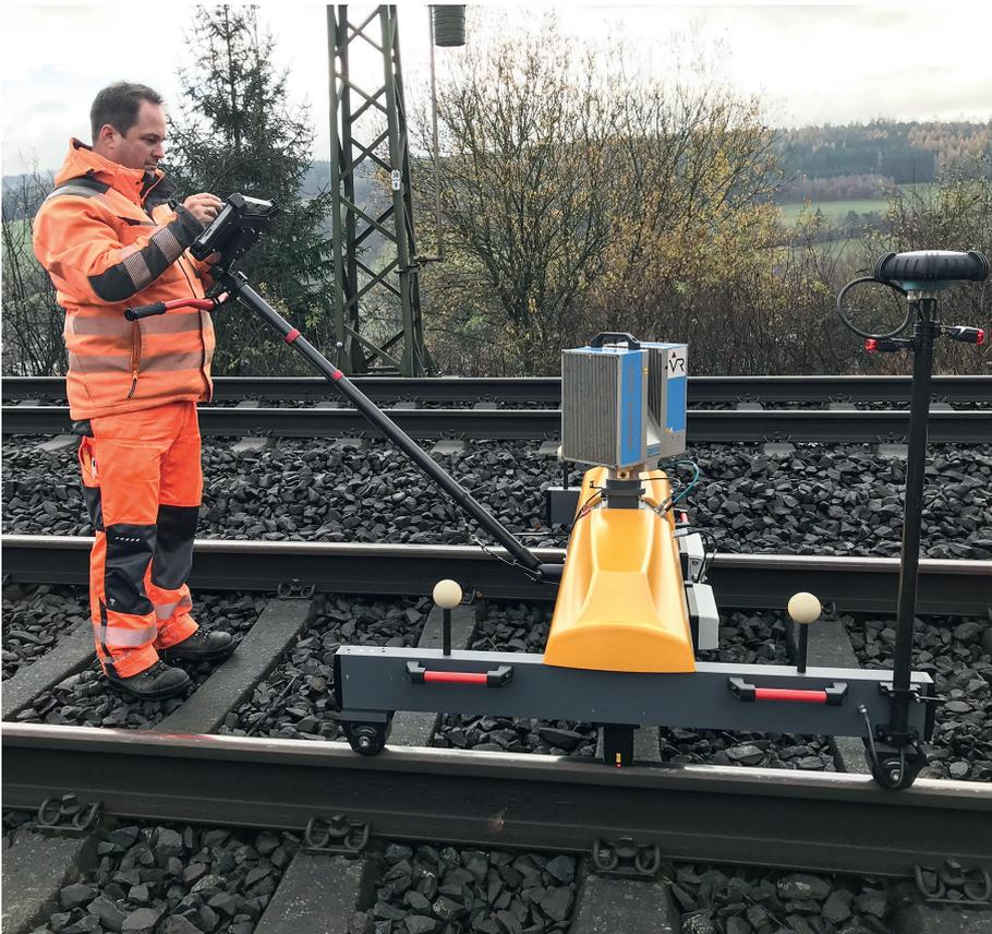
Abb. 3: Kinematisches Gleismesssystem SiTrack:One
