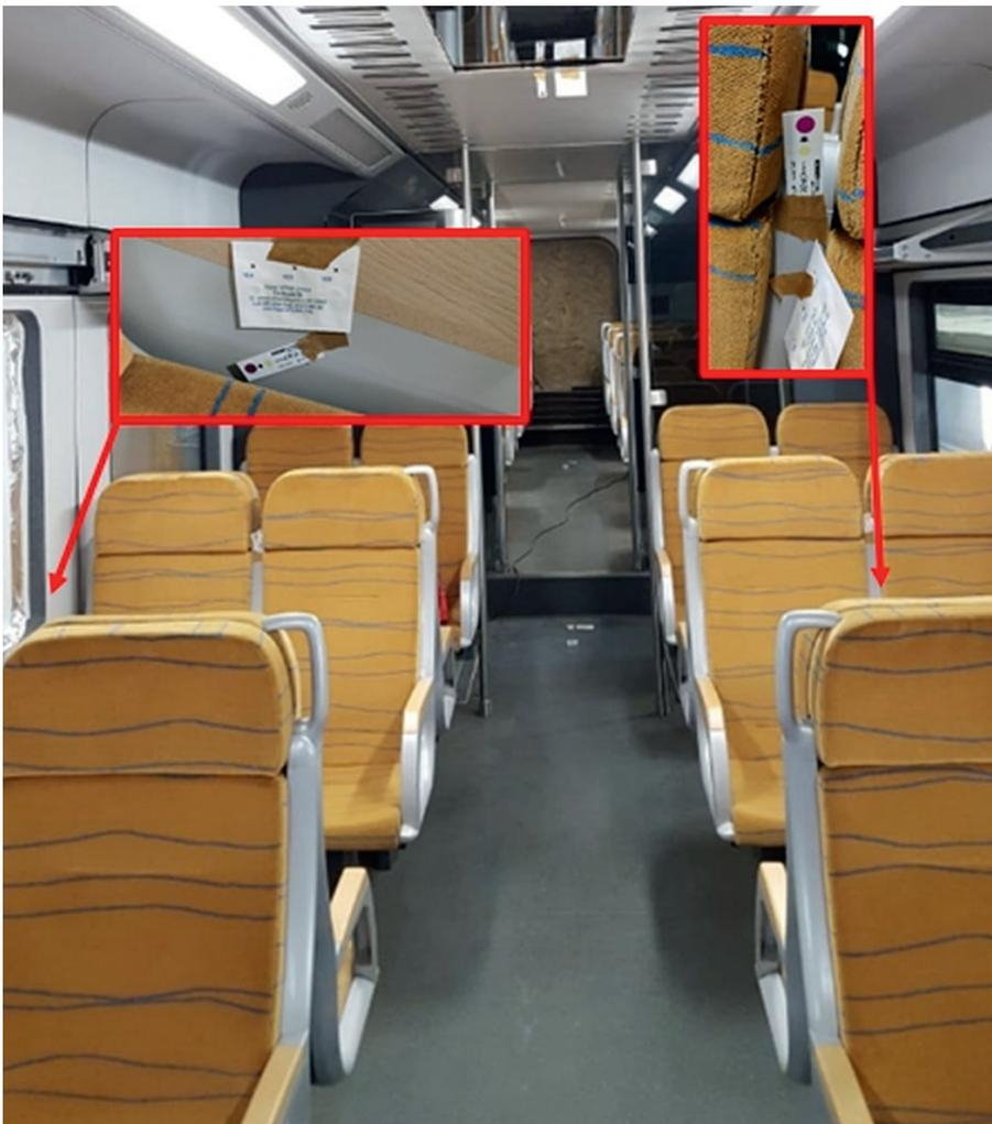
2: Versuchsmuster im Werk von Molinari Rail in Dessau mit Beispielen der Anordnung der chemischen und biologischen Indikatoren
