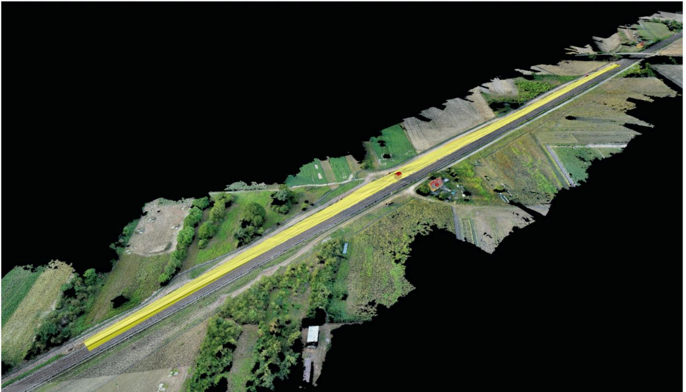
1: 3-D-Modell des Bodenaustauschs im Abzweigungsbereich der Neubaustrecke aus der Bestandsstrecke (eingebettet in eine Punktwolke) Quelle: Obermeyer
