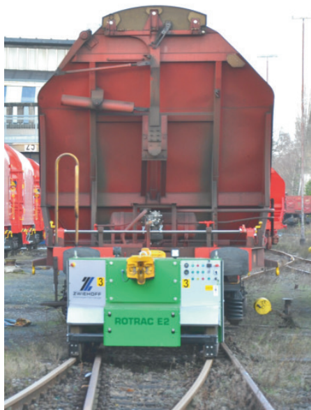
BILD 5: Ein Güterwagen wird in einem Pilotversuch automatisch rangiert
