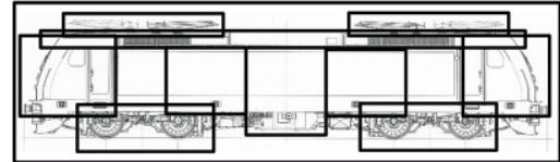
Lok der Baureihe 185 mit bis zu acht Revisionsabschnitten (Module) – Drehgestell, Führerraum, Stromabnehmer, Trafo, Klima etc.
