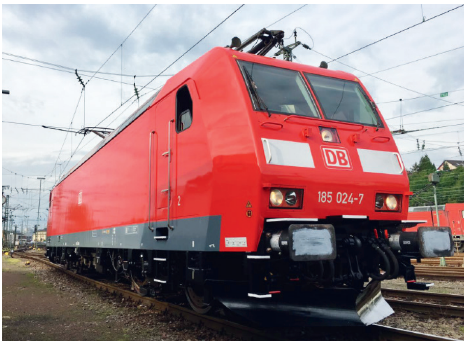
BILD 4: Lok der Baureihe 185.1 im Werk Saarbrücken. Im September 2017 wurden am Fahrzeug im Rahmen einer Modularen Revision u.a. beide Drehgestelle und alle vier Fahrmotorlüfter getauscht sowie die Zugeinrichtung erneuert. Dank der modularen Logik in der Revision werden weitere Maßnahmen z.B. in Stillagen umgesetzt, so dass die Lok bestmöglich im Betrieb verfügbar ist (Quelle: DB AG)
