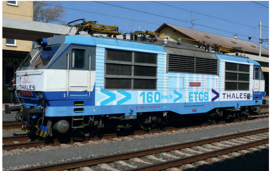
RESİM 4: Thales ETCS taşıt cihazına sahip ŠKODA HDV 350 Lokomotif
