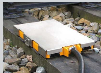
Bild 39: Beispiellösung Abschirmblech (hier: Balise auf der Holzschwelle)
