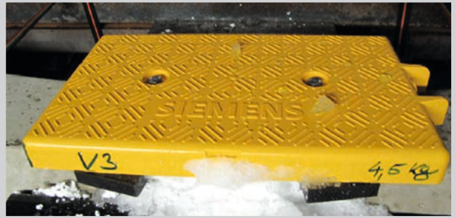
Bild 42: Eine im Versuch mit Eis beschossene Balise
