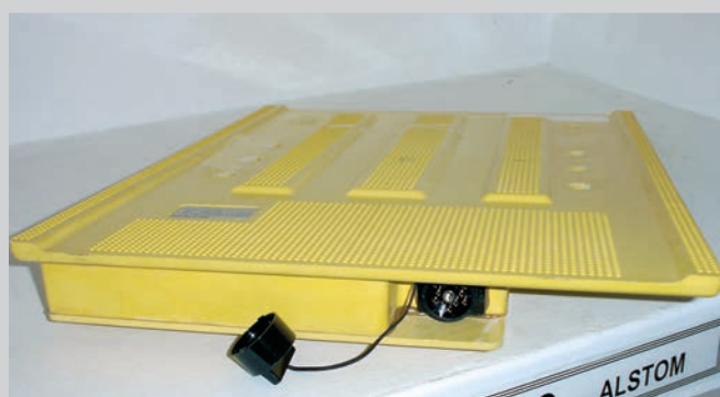
Bild 8: Standard-Balise der Firma Alstom
