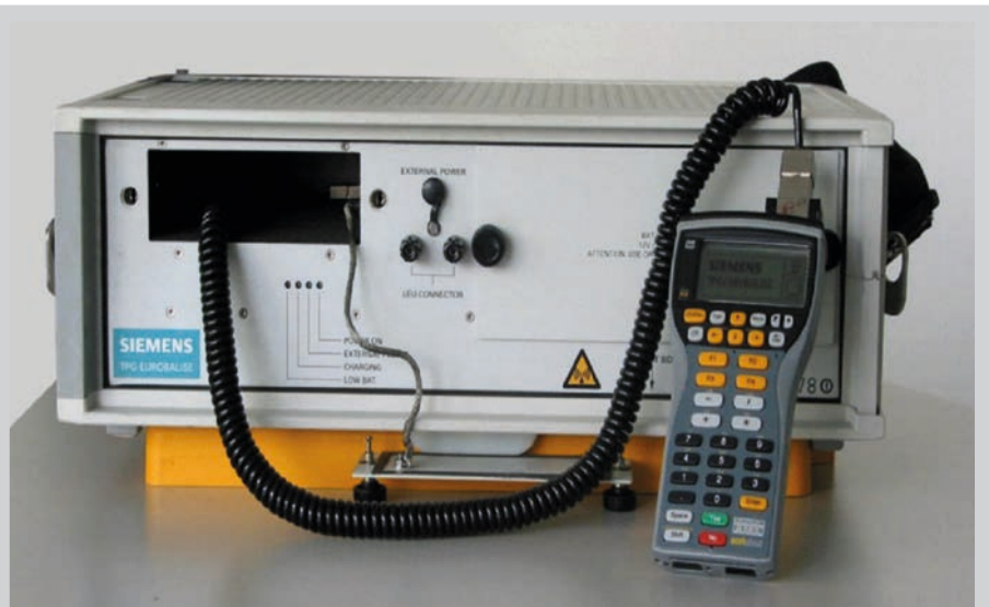
Bild 3: Prüfung der Balise S 21 mit tragbarem Prüfgerät (TPG) der Firma Siemens
