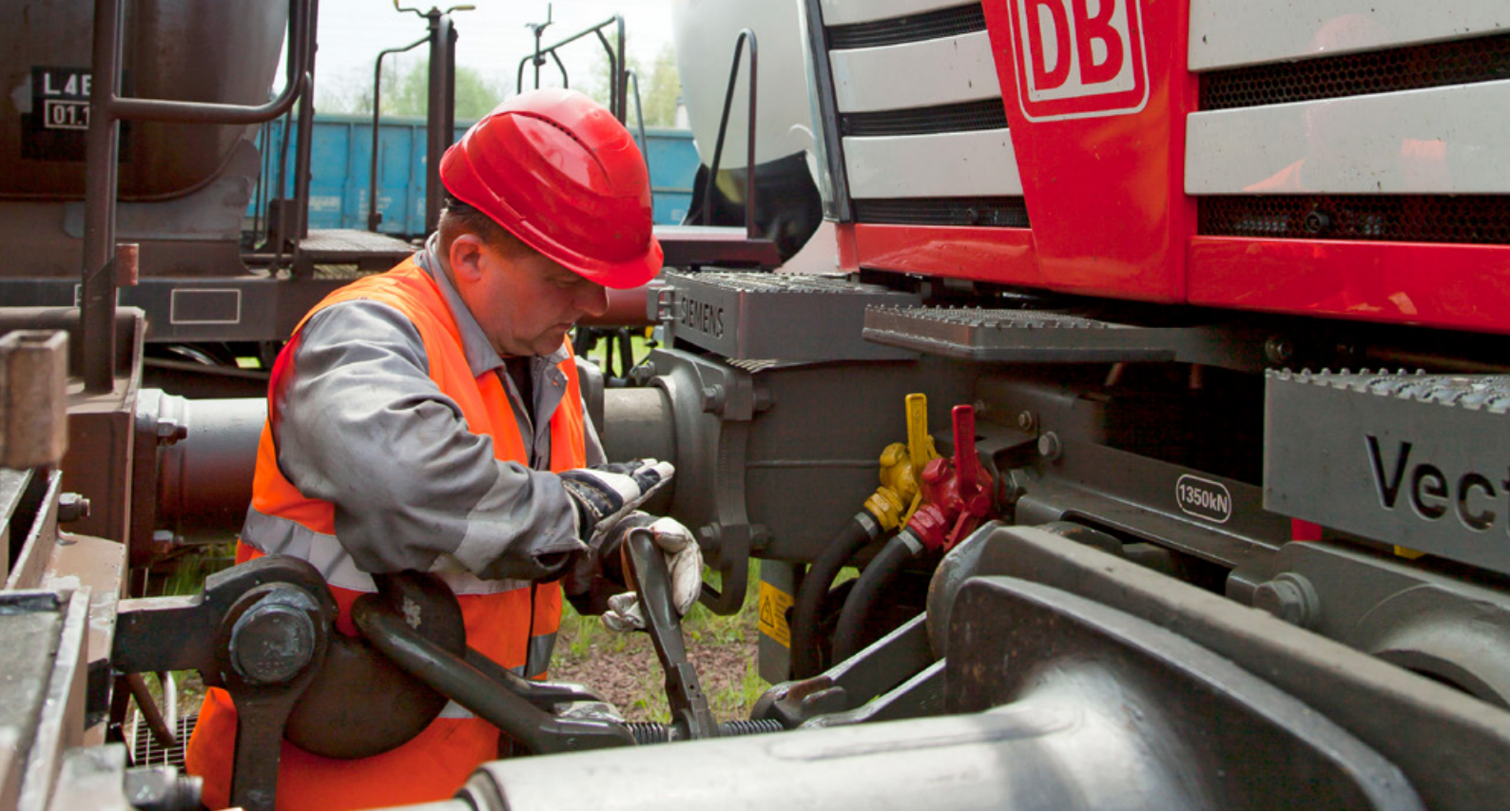
Die Handarbeit im Berner Raum könnte bald von automatischen Kupplungsvorgängen abgelöst werden. Foto: Deutsche Bahn AG / Bartłomiej Banaszak
