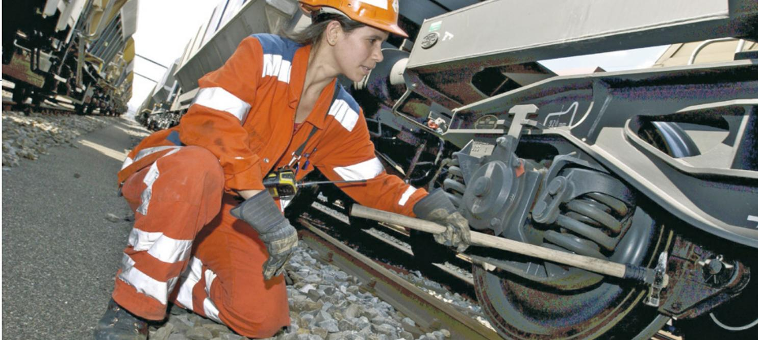
Bei der herkömmlichen Güterwagen-Bremsprobe müssen vor jeder Neuformierung eines Zugs die Bremsen von einem Mitarbeiter direkt am Wagen auf ihre Funktionalität geprüft werden. Dies kann bei einem 500 m langen Zug rund 40 Minuten dauern. Die automatische Bremsprobe soll innerhalb von 10 Minuten für den gesamten Zug erledigt sein.
