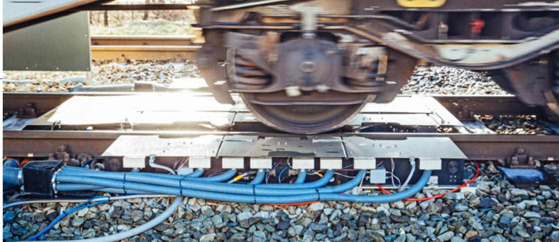
Die Railwatch-Messstelle zur Kontrolle von Radsätzen und Bremssystemen in Bremerhaven
