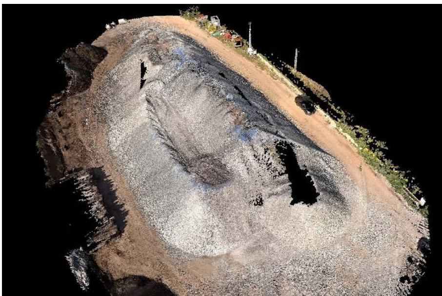
Abb. 7.: Erfassung eines Haufwerks auf einer Lagerfläche auf dem Projekt Hamburg – Berlin mit LiDAR
