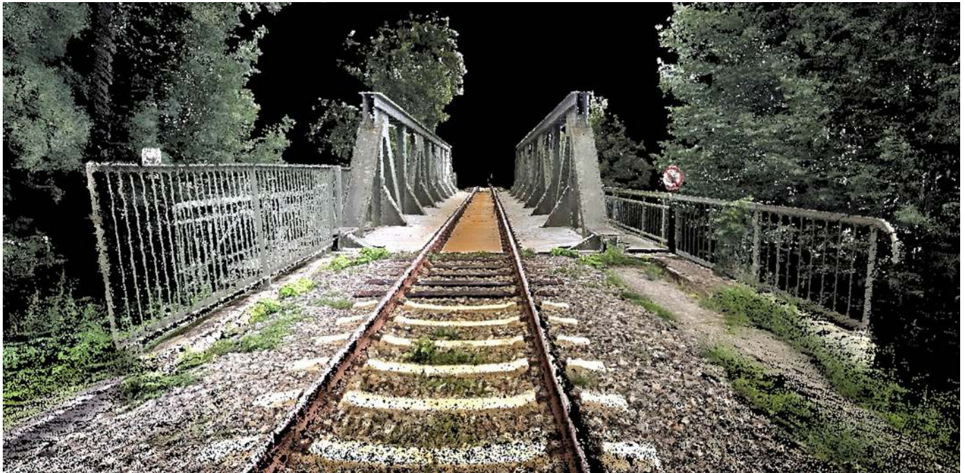
Abb. 6: Abbildung einer Eisenbahnüberführung als Punktwolke auf dem Projekt Neustadt-Glewe – Parchim, erfasst mittels LiDAR-Handscanner
