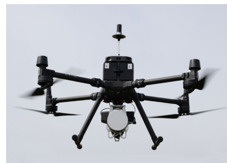
Abb. 2: Drohne (DJI M300 RTK) mit montiertem LiDAR-System für die Erfassung im Überflug
