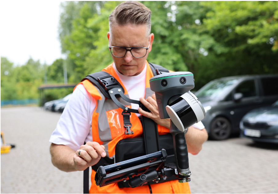
Abb. 3: Tragbares LiDAR-System (True View GO) mit Interface und ergonomischer Tragehilfe
