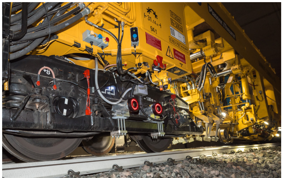
Abb. 4b: RTG-System aufgebaut auf einer Plasser & Theurer-Stopfmaschine
