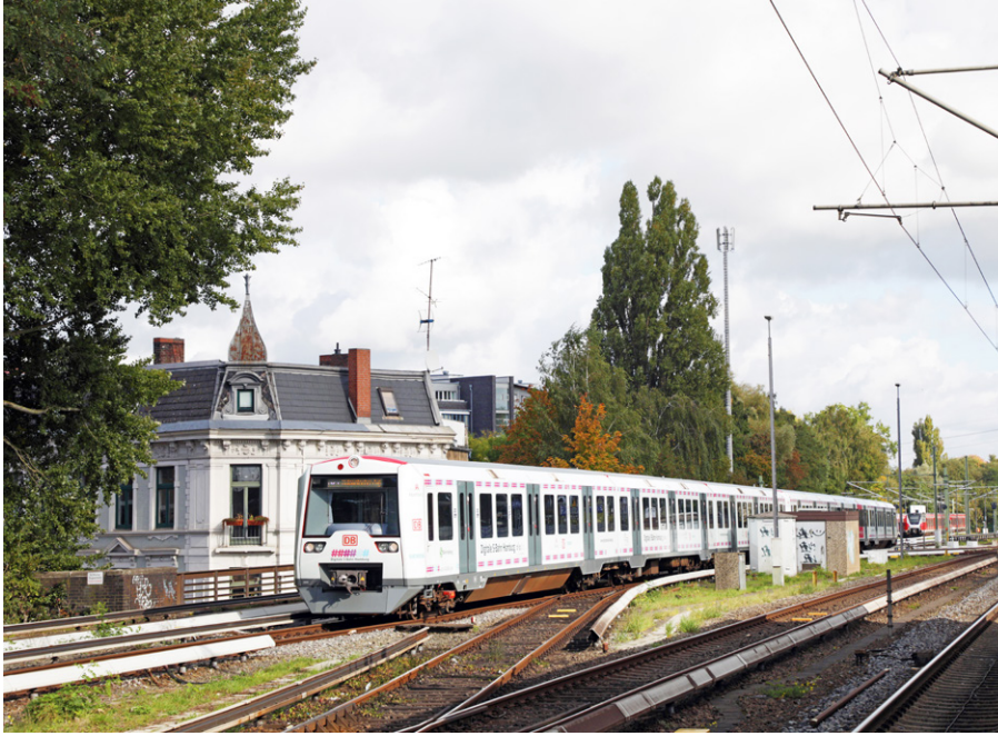
4: Versuchsweiser automatischer Abstellbetrieb nach GoA4 ohne Fahrer in Hamburg Bergedorf
