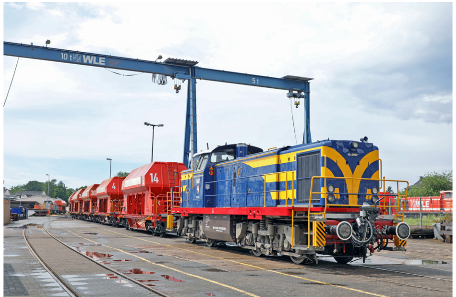
6: Der erste Zug, bei dem Waggon und Lok mit dem DAK ausgerüstet sind
