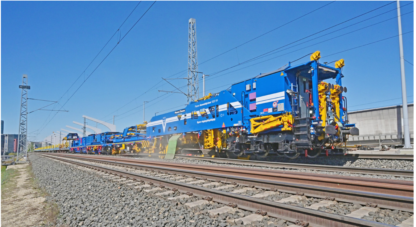
5: Plasser AssemblyLiner 1020 bei Gleisrückbau in Budapest im Frühjahr 2026
