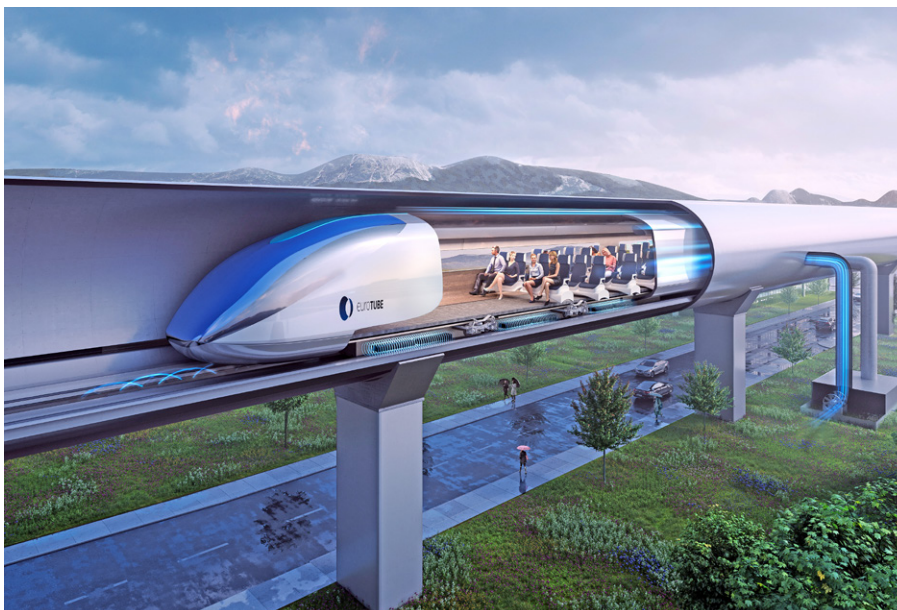
1: Die Hyperloop-Technologie sieht ein Magnetbahnsystem in Unterdrucktunneln vor, das hohe Geschwindigkeit mit niedrigen Emissionen und Energieverbrauch ermöglichen soll Quelle: EuroTube Foundation
