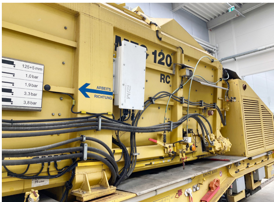
4: Aufbau des WaggonTracker auf der MFS 120 RC
