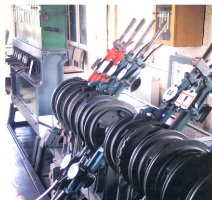
6: Mechanisches Stellwerk, aus [2]
